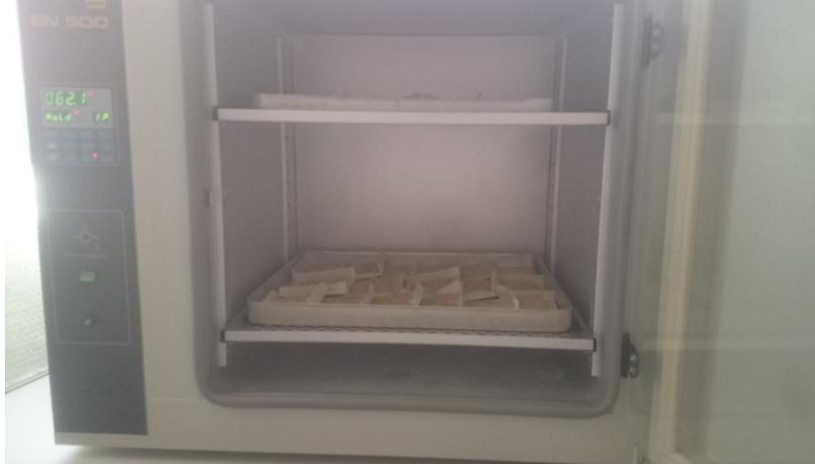
Resim 19. Etüvde Kurutma İşlemi 1
