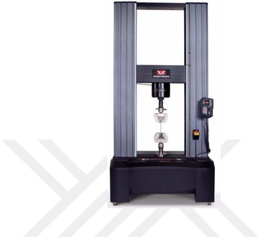
Resim 4.1Tendonların Çekme Testinde Kullanılan Çekme Cihazı
