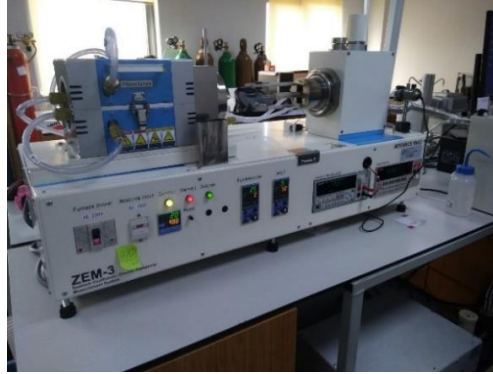
Şekil 5.6 : ZEM-3 Seebeck Ölçüm Cihazı.
