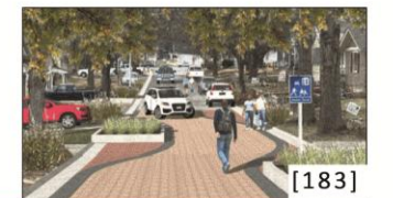
[183] Taşıt hızını yavaşlatması için döşeme farklılığı ile oluşturulan kavisli taşıt izi
