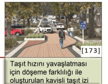
[173] Taşıt hızını yavaşlatması için döşeme farklılığı ile oluşturulan kavisli taşıt izi
