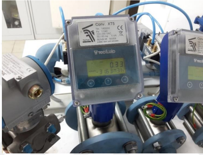
Şekil 6.4 : Test düzeneğinde debi ölçümü.
