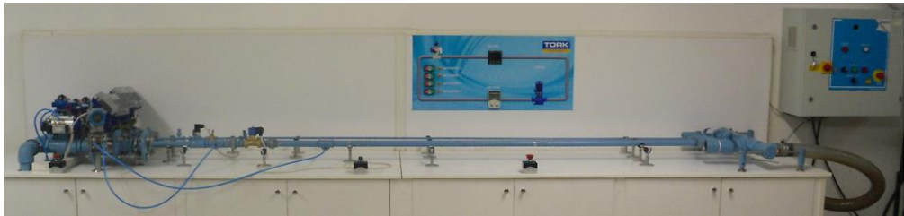
Şekil 6.3 : Solenoid akış performans ölçümü test düzeneđi.
