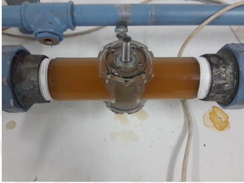
Şekil 6.10 : Türbinin test düzeneğine bağlanması.
