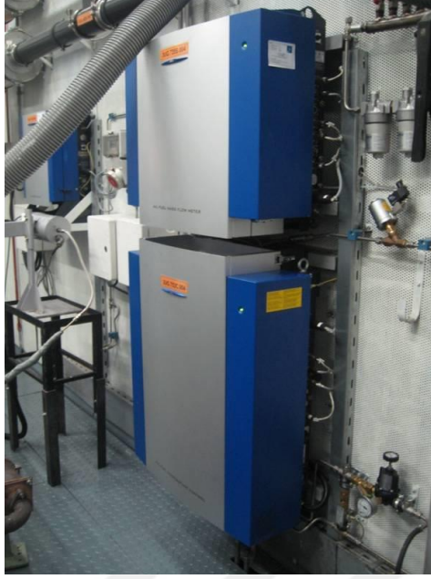
Şekil 4.5 AVL 735S yakıt tüketim ölçüm cihazı, AVL 753C yakıt şartlandırıcı
