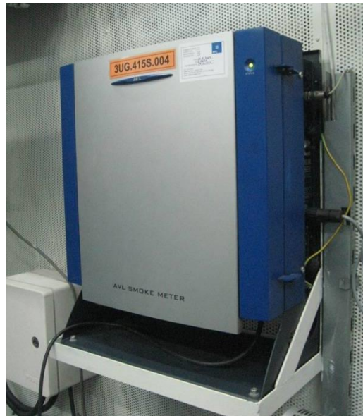
Şekil 4.4 AVL 415S is ölçüm cihazı
