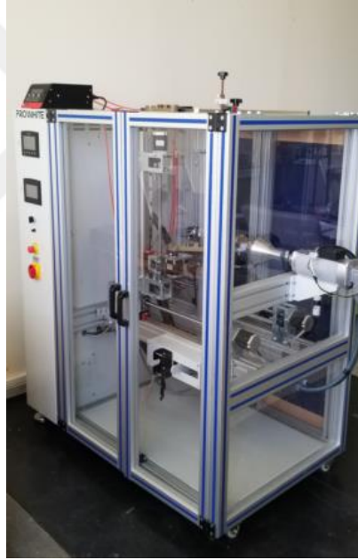
Şekil 5.8. PLC kontrollü nanolif iplik eęirme makinesi
