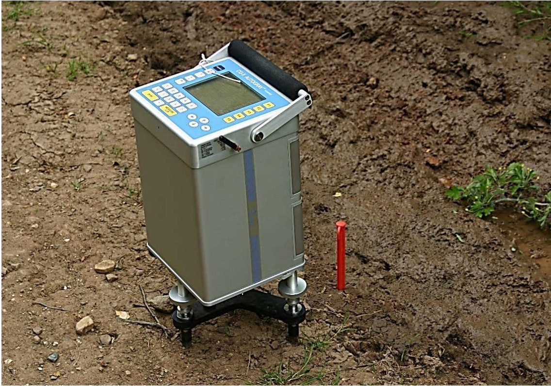
Şekil 2.19: Scintrex CG-5 otomatik gravimetre cihazının üçayağı ile birlikte görünümü
