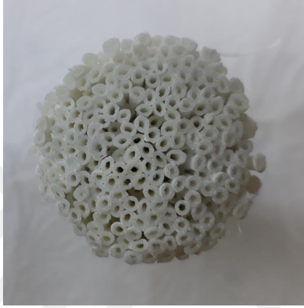
Şekil 3.4. Çalışmada kullanılan hallow fiber UF membranı
