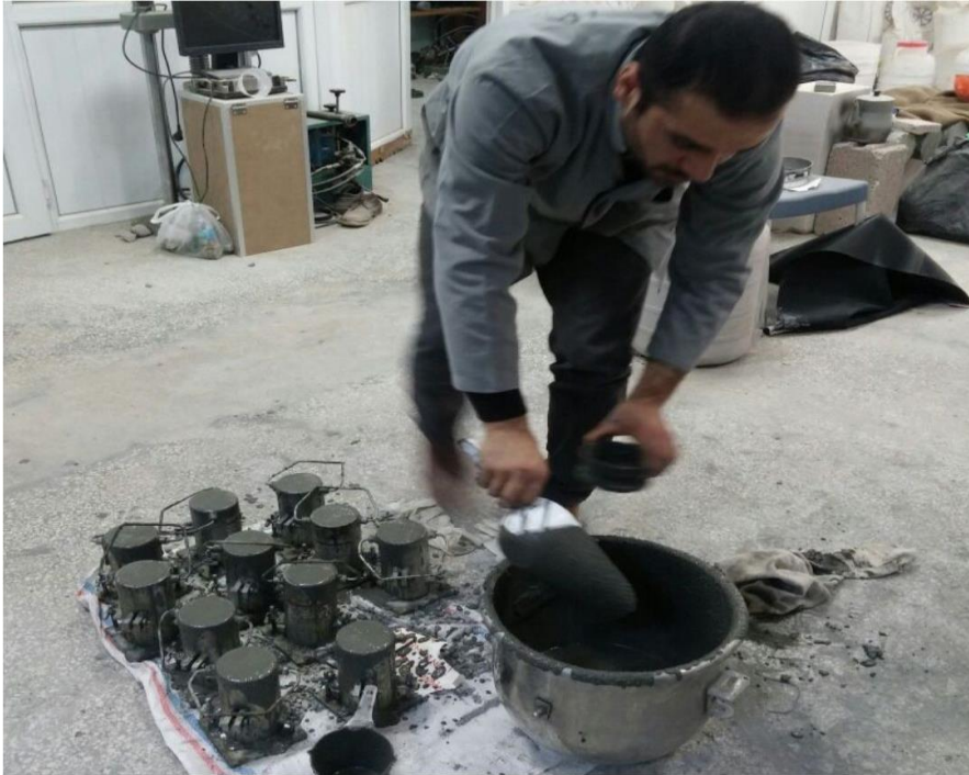
Şekil 3.2. \phi 75 \times 150 mm boyutunda silindir numune üretimi
