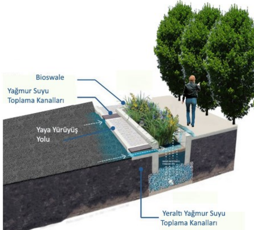
Şekil 5.3. Bioswale ve suyun akış şeması (Orj., 2017)
