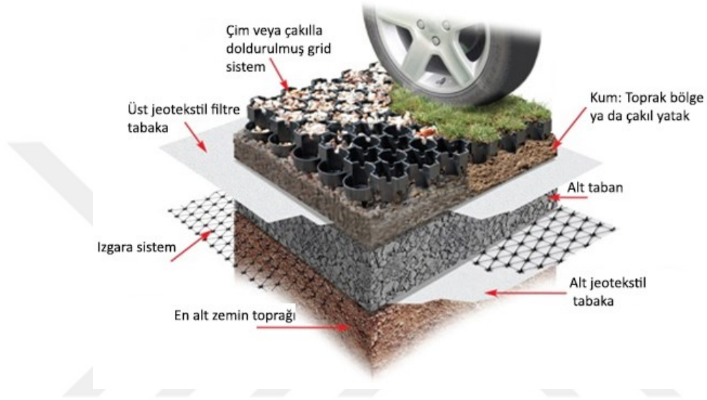
Şekil 5.1. Otopark zeminleri için yeşil ızgara sistemi ve katmanları (Landscape Discount, 2018)
