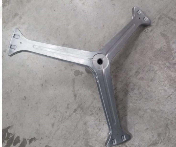
Şekil 5.1 : Yeni tasarıma göre değişiklik yapılmış flanş mil grubu.
