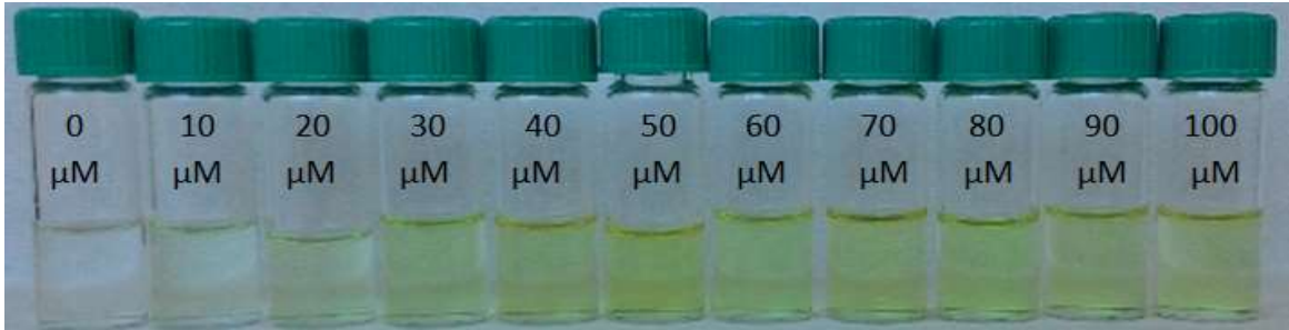
Şekil 4.51. (24) (10 \mu M)'ün THF'deki çözeltisinin CN - iyonlarının artan konsantrasyonlarında (0-100 \mu M) gün ışığındaki görünümü
