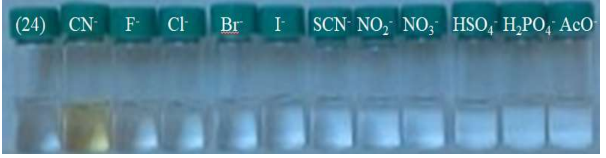
Şekil 4.47. THF çözücü ortamında (24) (10 \mu\text{M} )'ün farklı anyonlar varlığında (10 ekiv.) gün ışığındaki görünüşleri
