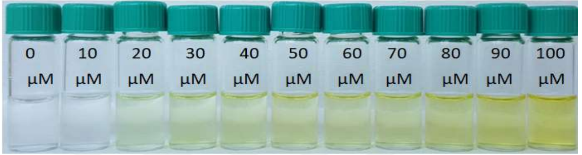
Şekil 4.40. (23) (10 µM)'ün asetonitrildeki çözeltisinin CN - iyonlarının artan konsantrasyonlarında (0-100 µM) gün ışığındaki görünümü
