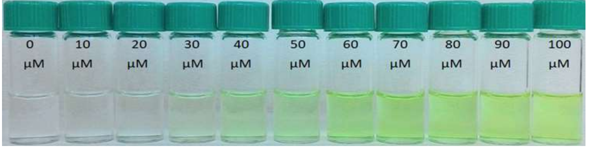
Şekil 4.30. (22) (10 µM)'nin asetonitrildeki çözeltisinin F - iyonlarının artan konsantrasyonlarında (0-100 µM) gün ışığındaki görünümü
