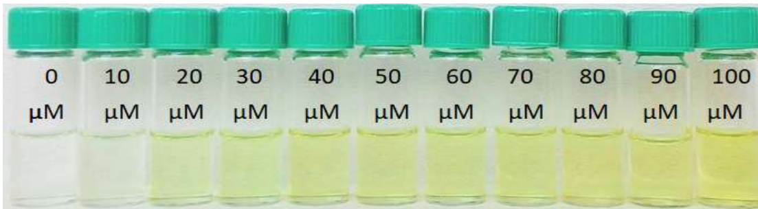
Şekil 4.27. (22) (10 \mu M)'nin asetonitrildeki çözeltisinin CN - iyonlarının artan konsantrasyonlarında (0-100 \mu M) gün ışığındaki görünümü
