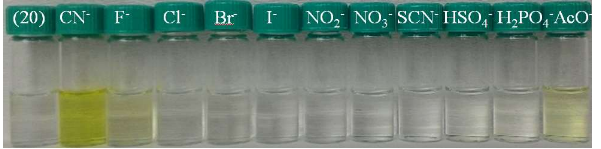
Şekil 4.7. Asetonitril çözücü ortamında (20) (10 \mu\text{M} )'nin farklı anyonlar varlığında (10 ekv.) gün ışığındaki görünüşleri
