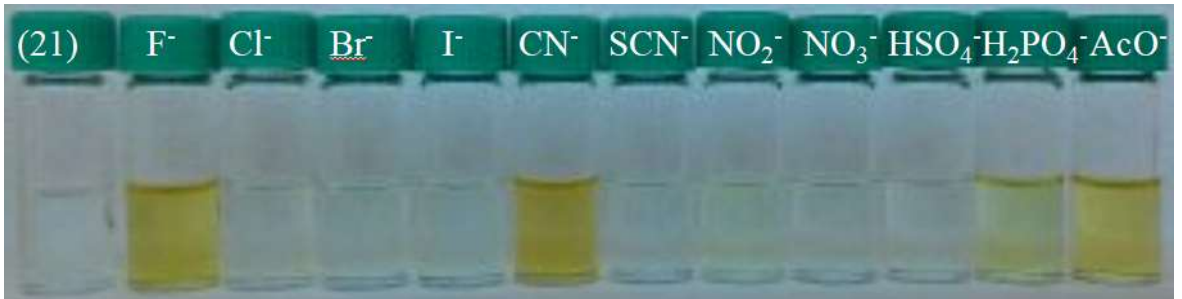
Şekil 4.14. Asetonitril çözücü ortamında (21) (10 \mu M )'in farklı anyonlar varlığında (10 ekiv.) gün ışığındaki görünüşleri
