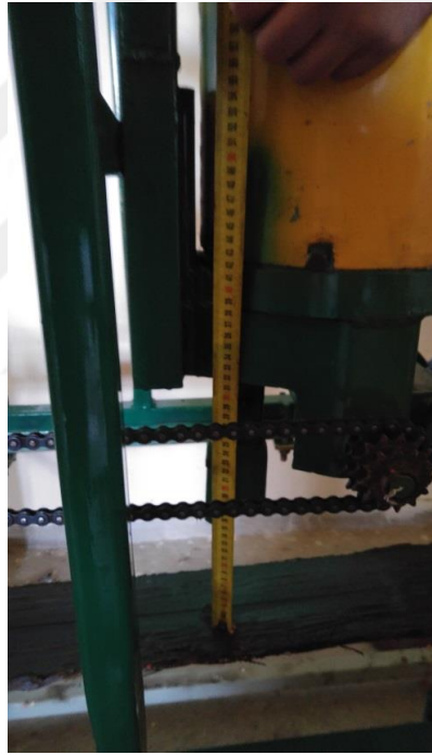
Sekil 3.10. Tohum düşme yüksekliğinin ayarlanması
