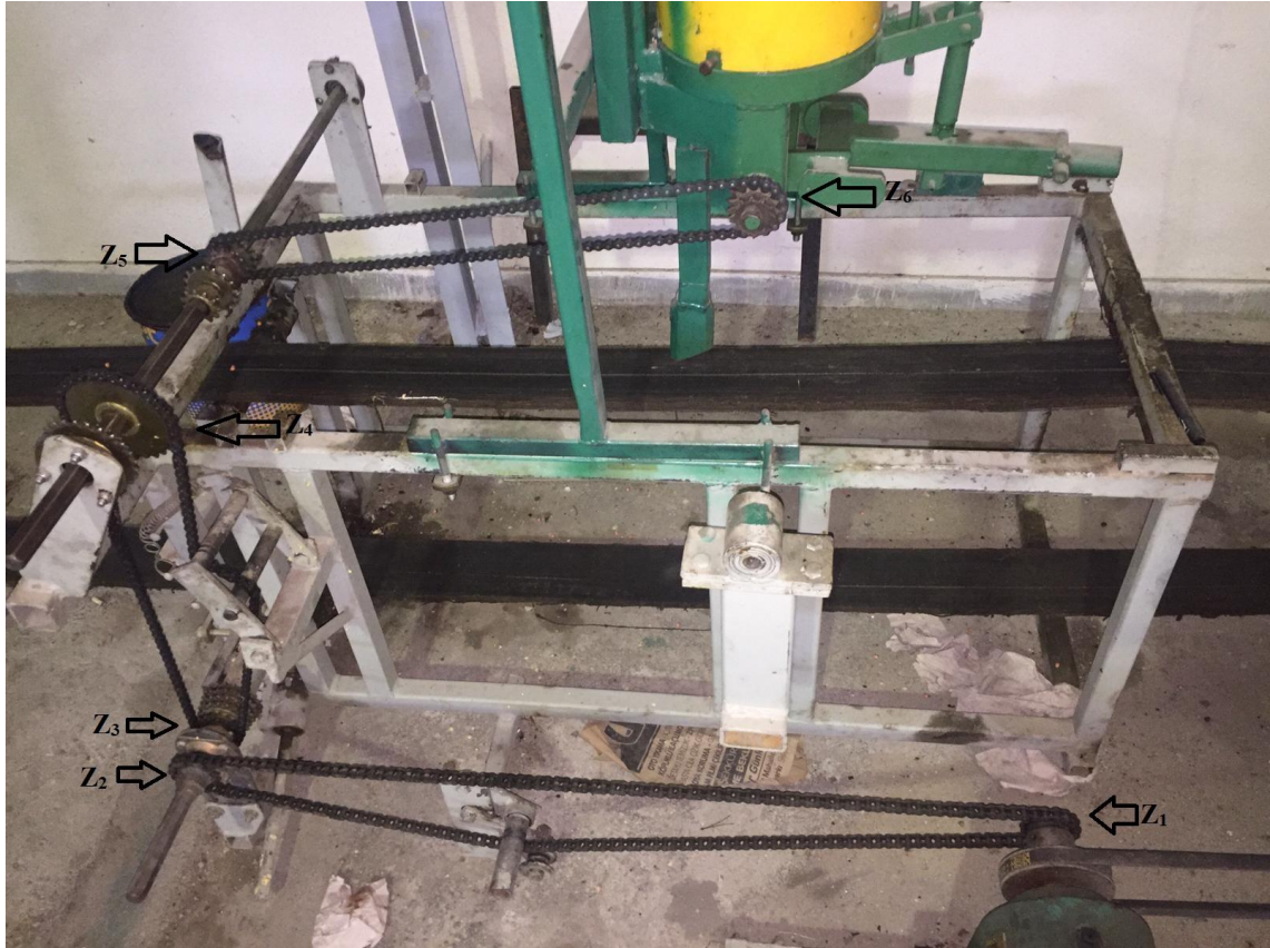
Şekil 3.4. Yatay plakalı tek dane ekici düzenin hareket iletim düzeni
