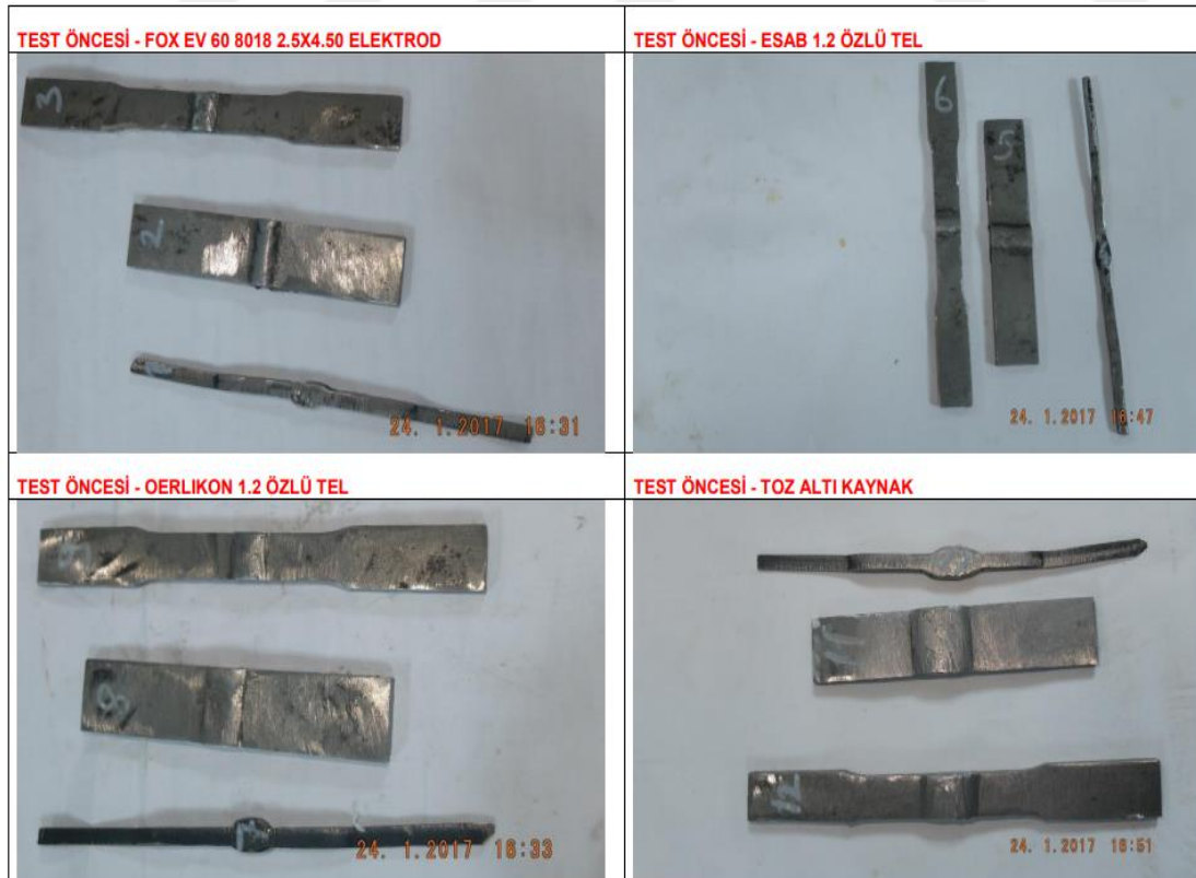
Resim 7.1. Korozyon Testi öncesi numune resimleri
