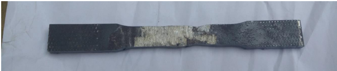
Resim 7.4. ASTM-E8 standardına göre üretilen çekme test numunesi
