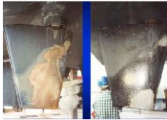
Resim 5.7. Gemi uskurunda görülen kavitasyon korozyonu
