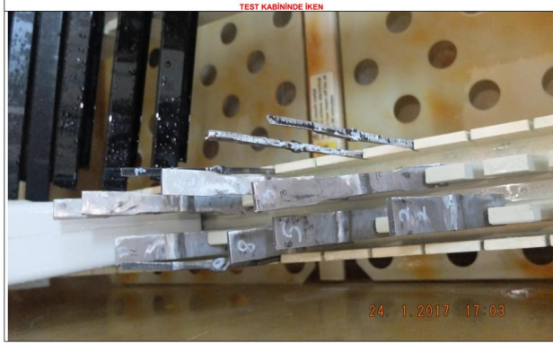
Resim 7.2. Korozyon Testi öncesi numune test kabini içinde iken çekilen resim
