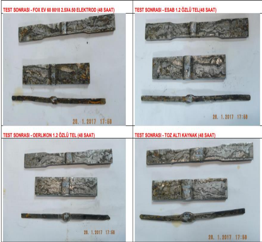
Resim 7.3. Korozyon Testi sonrası numune resimleri
