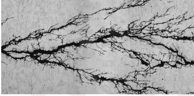
Resim 5.3. Gerilmeli korozyon çatlağı [40]
