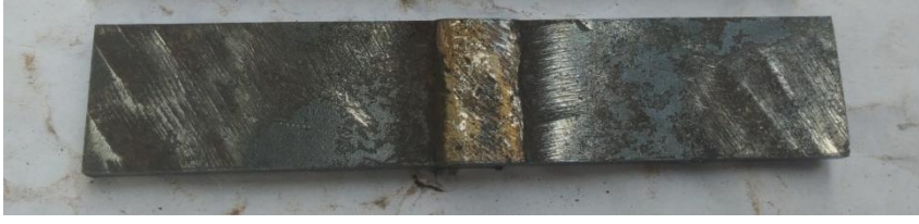
Resim 7.5. Eğme deneyi öncesi numune görüntüsü
