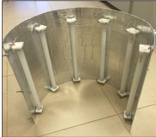
Şekil 4.5: Hibrit sistem için geliştirilen ışık sistemi.
