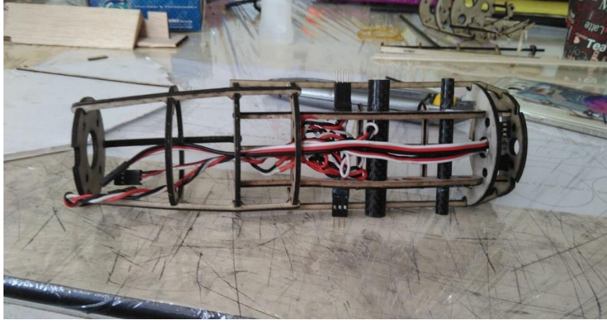
Şekil 7.3. Jaeger Mini İHA Aşap Gövdesi
