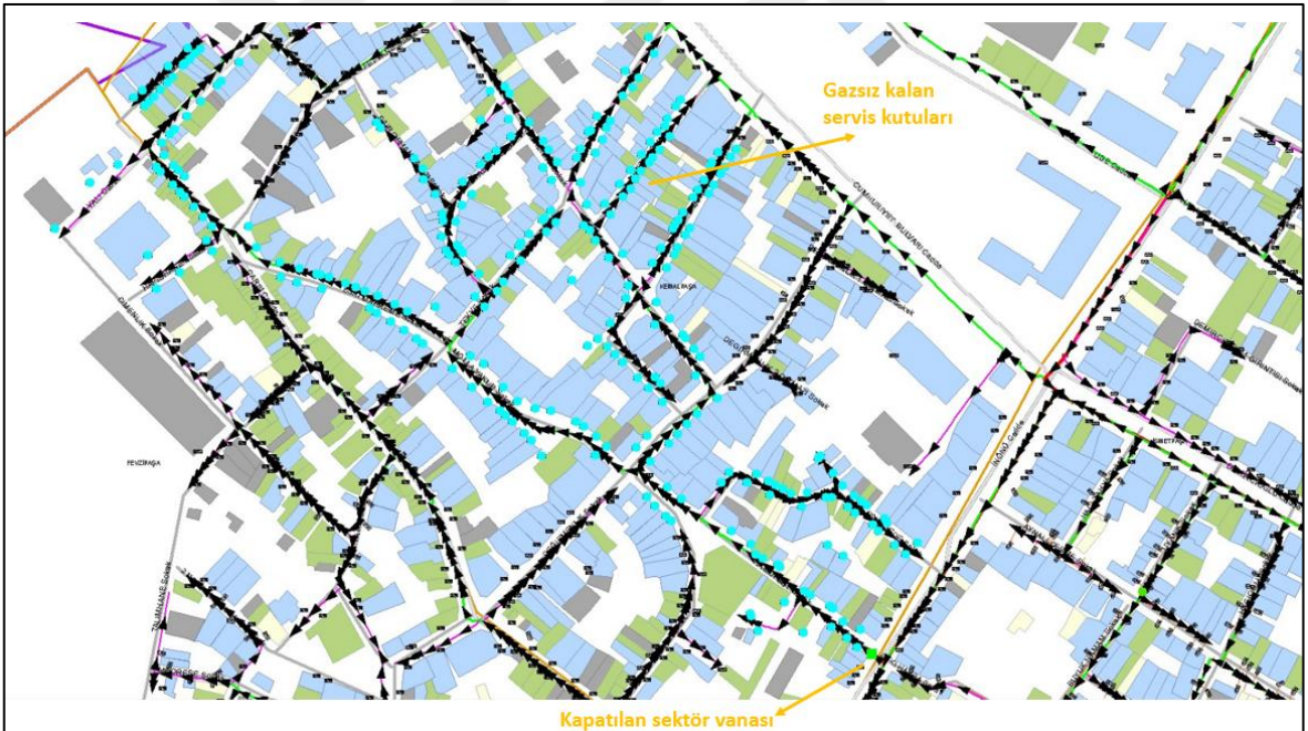
Şekil 4.67. Çarşı bölgesi, kapatılan doğal gaz hattı sektör vanası sonrası gazsız kalan servis kutuları
