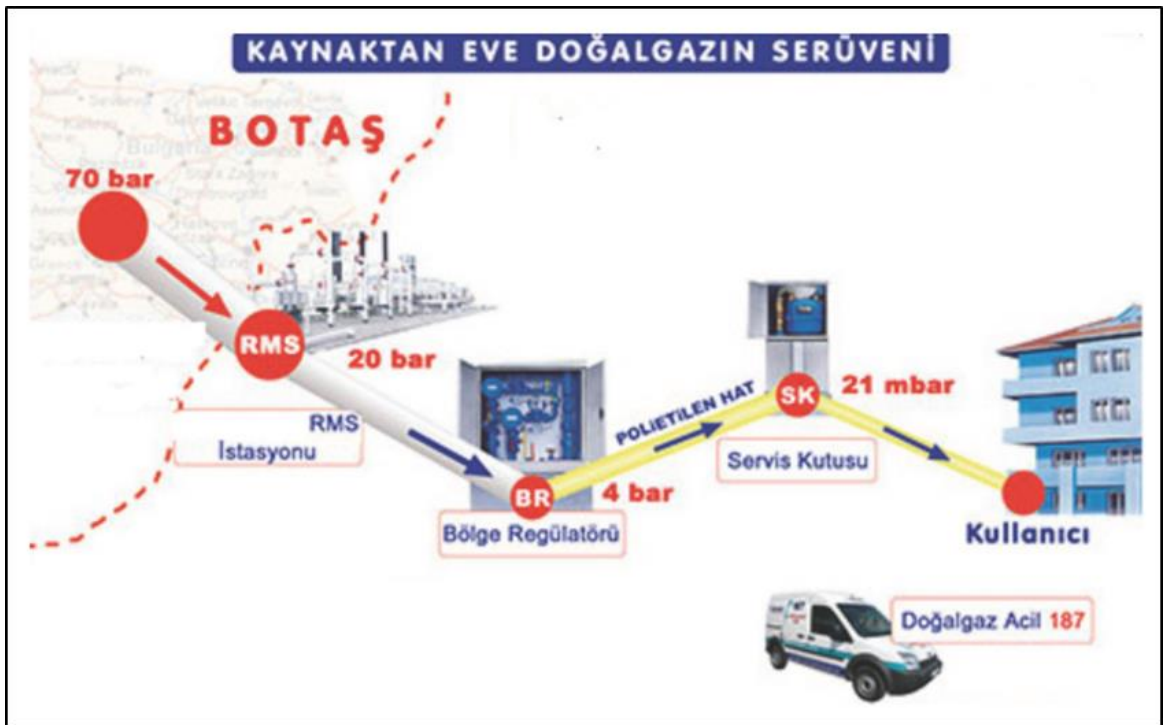
Şekil 3.4. Yüksek basınçtan kullanıcıya doğal gaz ulaşımı
