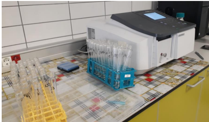
Fotoğraf 3.6. Örneklerin spektrofotometrede okunuşu
