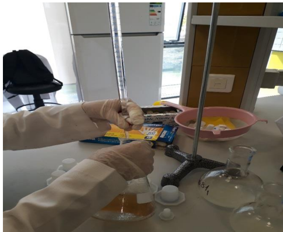
Fotoğraf 3.5. Peroksit değerini belirlemek amacıyla yapılan titrasyon işlemi
