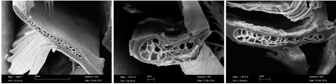
Şekil 5.7. 80°C’de yıkanmış olan tüylerden elde edilen lifin SEM görüntüsü
