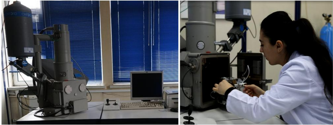
Şekil 4.8. Leo440 marka taramalı elektron mikroskobu (SEM)
