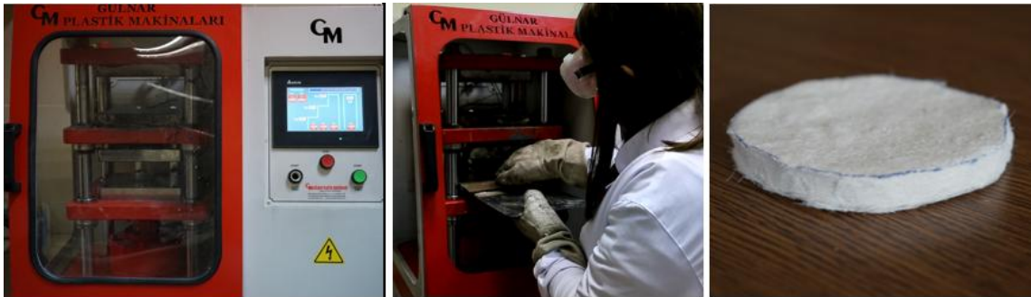
Şekil 4.21. Numunelerin üretildiği sıcak pres ve üretilmiş dokusuz yüzey numunesi
