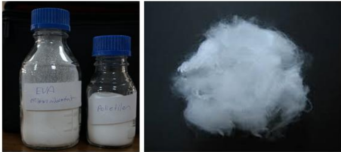
Şekil 4.19. Deneylerde kullanılan polietilen, etilenvinilasetat ve bikomponent lif
