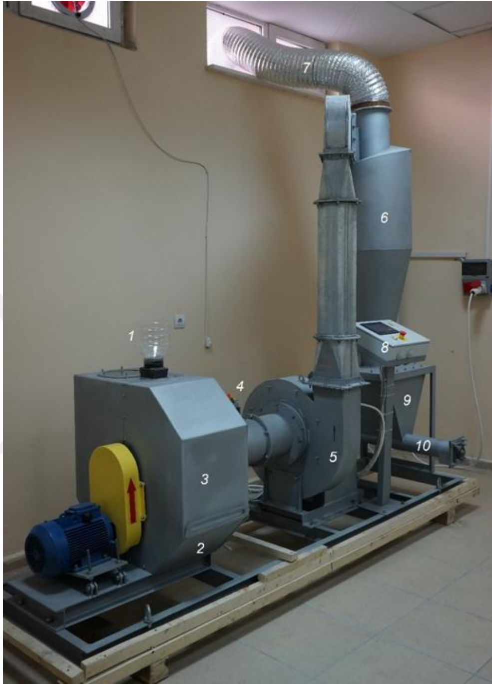
Şekil 4.6. Tavuk tüyünden lif üretim makinesi
