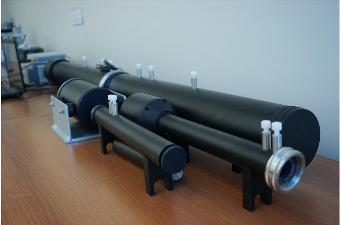
Şekil 4.29. BSWA TECH markalı empedans tüpü cihazı
