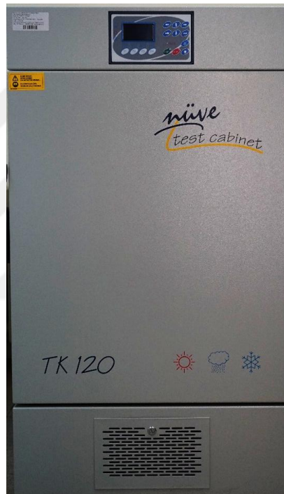
Şekil 4.12. Nüve marka iklimlendirme test kabini
