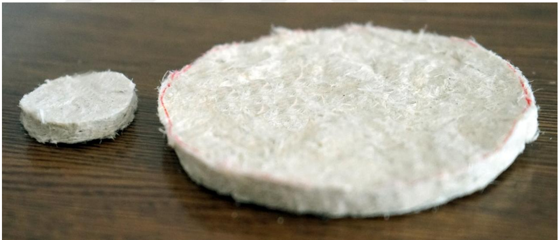
Şekil 4.25. Islak serme ve kimyasal bağlama yöntemi ile üretilmiş numuneler
