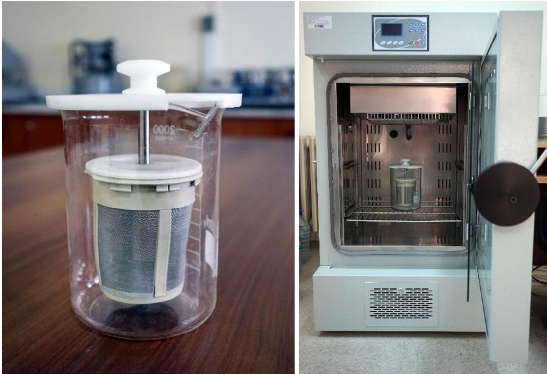
Şekil 4.13. Liflerin su emme kapasitesinin tayini için tasarlanmış deney düzeneği
