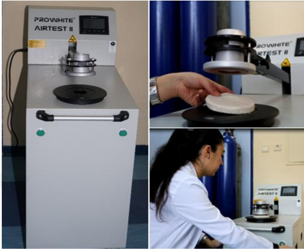
Şekil 4.28. Hava geçirgenlik test cihazı
