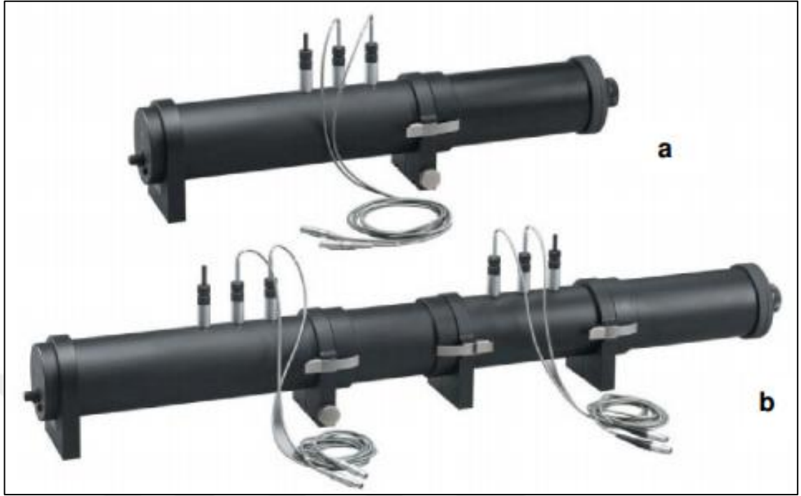
Şekil 4.32. Ses yutum katsayısı(a) ve ses iletim (b) katsayısı ölçümü için tüp pozisyonu
