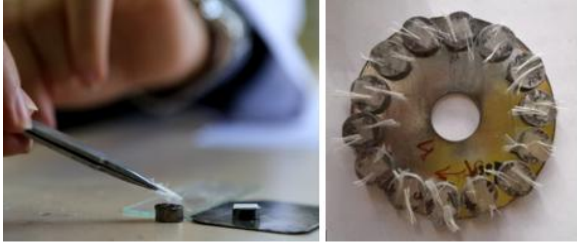
Şekil 4.9. Liflerin SEM ve EDX analizi için hazırlanması
