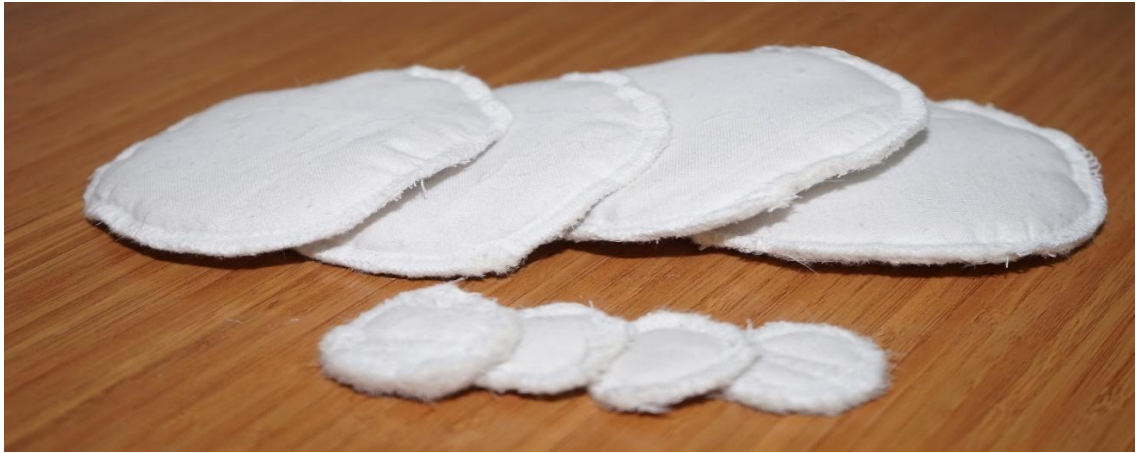
Şekil 4.23. Mekanik bağlama yöntemiyle üretilmiş numuneler
