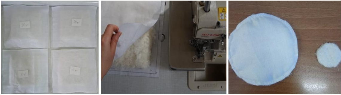
Şekil 4.22. Tavuk tüyü liflerinden mekanik yöntemle üretilen kapitone yüzey numuneleri
