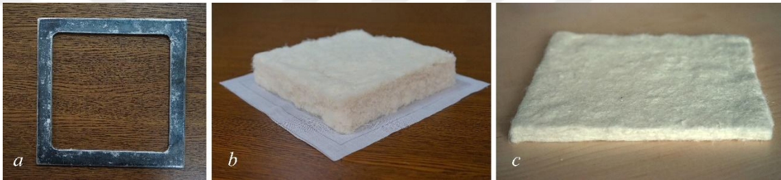
Şekil 4.20. Tavuk tüyü liflerinden dokusuz yüzey oluşum aşaması
