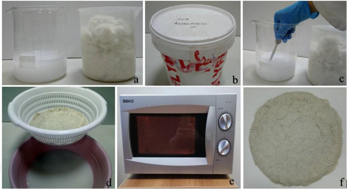
Şekil 4.24. Tavuk tüyü liflerinden kimyasal yöntemle üretilen dokusuz yüzey numuneleri (a-emülsiyon ve lif, b-pva tutkalı, c-karışım hazırlanması, d-yüzey oluşumu, e-mikrodalga fırın, f-üretilmiş yüzey)
