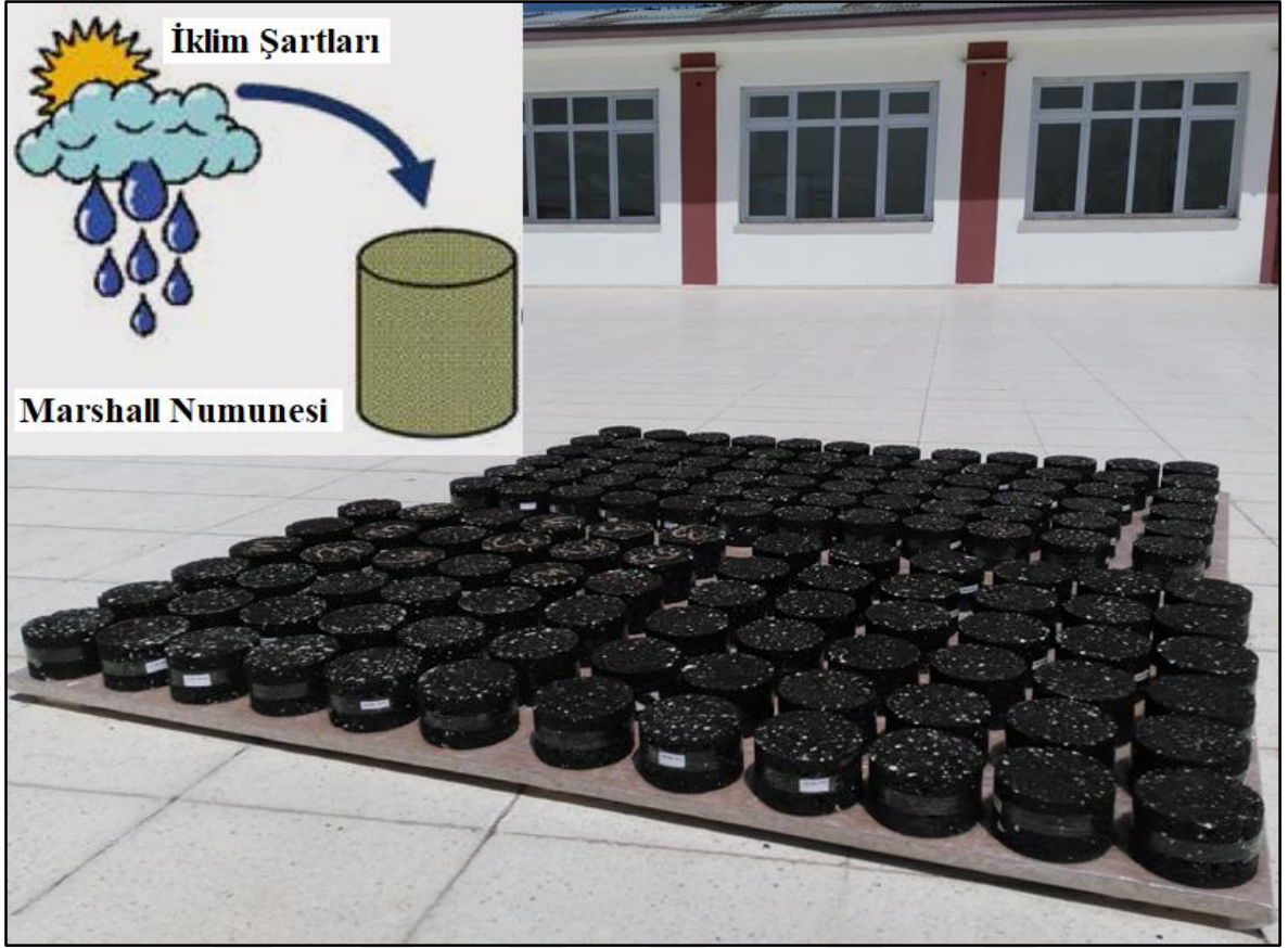
Şekil 5.12. Çevresel koşullar altında yaşlanmaya bırakılan numuneler
