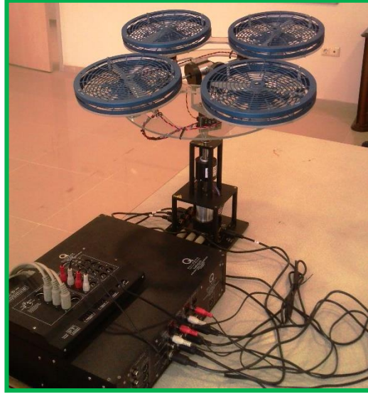
Şekil 3.1 Üç serbestlik dereceli dört motorlu kuadroptör sistemi (3 DOF Hover) deney seti düzeneği
