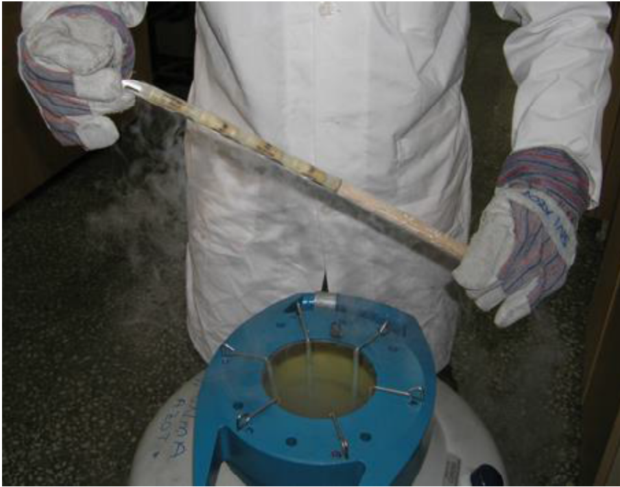
řekil 3.6. Rumen fungus kltrleri karyovialler ierisinde alminyum kamıřlara sabitlenerek sıvı azot ierisine bırakılmıřtır.
