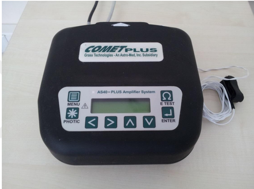
Şekil 3.1: Polisomnografi testlerinin yapıldığı COMET AS40 Amplifier Sistemi cihazı. (GATA Psikiyatri Anabilim Dalının izniyle)
