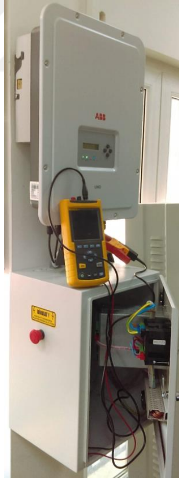
Şekil 5.16: Evirici çıkışı için güç kalitesi ölçüm düzeneği
