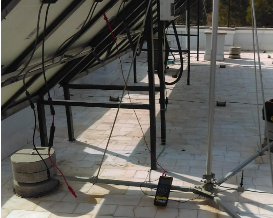
Şekil 5.7: FV modül çerçevesi toprak geçiş direnci ölçümü için kurulan sistem
