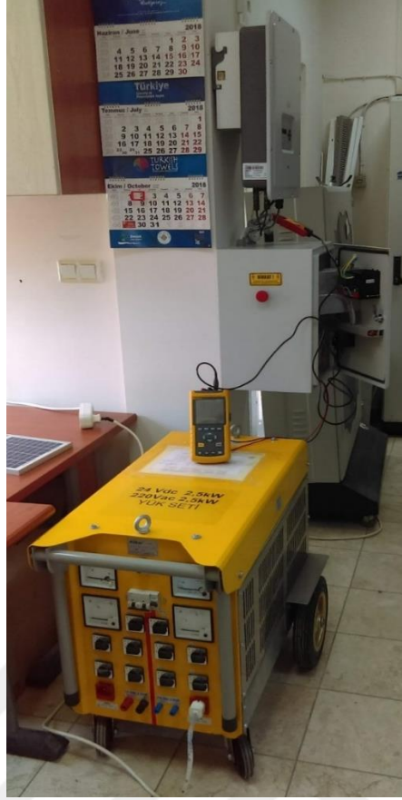
Şekil 5.20: Evirici çıkışı rezistif yük bankı test düzeneği
