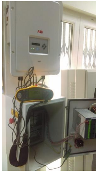
Şekil 5.14: L-PE çevrim empedansı ölçüm düzeneği
