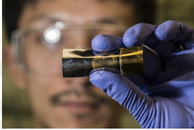
Şekil 3.4: İnce film fotovoltaik hücre (Yang ve diğ. 2014)
