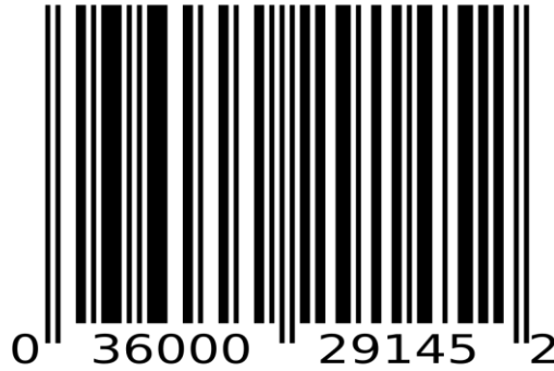
Şekil 2.3 UPC-A Standardında bir çizgi barkod etiketi örneği
