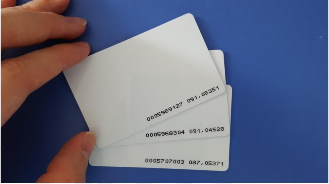
Şekil 4.23 Sistemde kullanılan RFID kartlar (Proximity Tipi)
