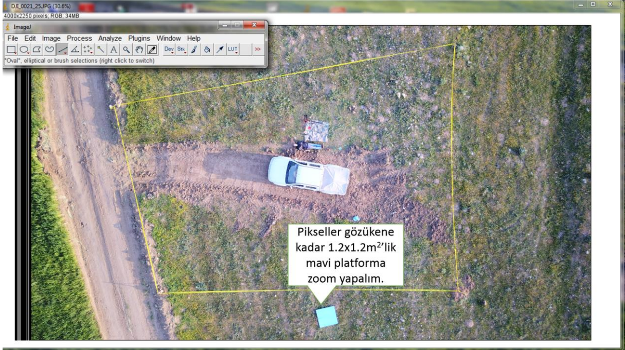
Şekil 45: Ölçek görevi görecek objenin (mavi platform) “ImageJ” ile büyütülmesi.
