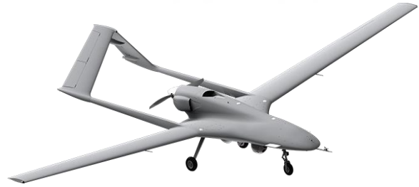
Şekil 5: Bayraktar TB2 Taktik İnsansız Hava Aracı, Azami kalkış ağırlığı: 600kg (54,55).
