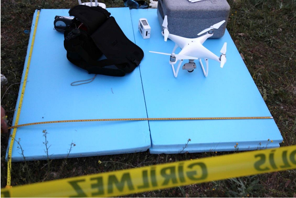
Şekil 23: Dronlar için iniş-kalkış platformu, hava görüntüleri için yön ve ölçek olarak kullanılan 1,44m 2 lik mavi alan.
