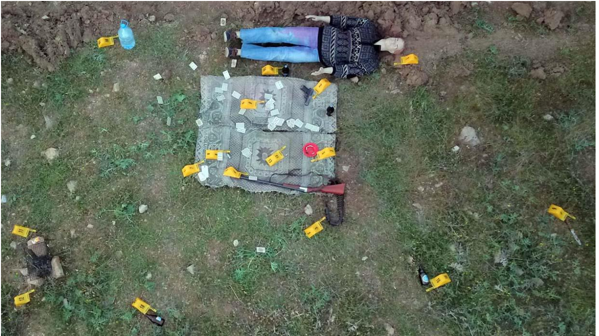
Şekil 37: DJI Mavic Pro'nun pervane rüzgarı ile bozulan sahte olay yeri. (İrtifa: 3,5m)
