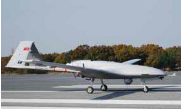
Şekil 5: Bayraktar TB2 Taktik İnsansız Hava Aracı, Azami kalkış ağırlığı: 600kg (54,55).
