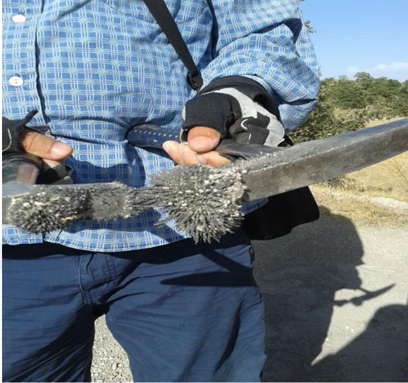
Şekil 4. 14. İnceleme alanında gözlenen manyetitlerin mıknatıs üzerindeki görüntüsü.
