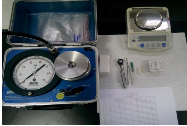
Şekil 3.3. Su potansiyeli bileşenlerin tespitinde kullanılan bitki basınç odası cihazı ve yardımcı ekipmanlar
