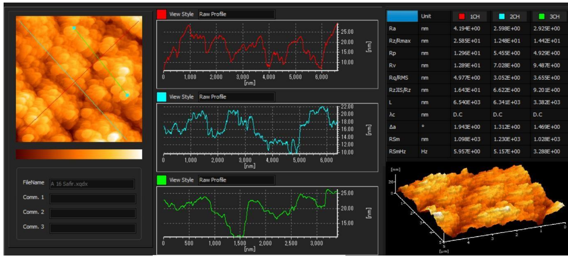
Şekil 4.24. Safir üzerine büyütülmüş AlN filmlerinden B7 filminin AFM ile alınmış görüntüsü
