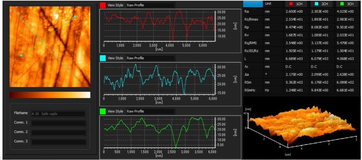
Şekil 4.42. Safir üzerine büyütülmüş AlN filmlerinden B13 filminin AFM ile alınmış görüntüsü
