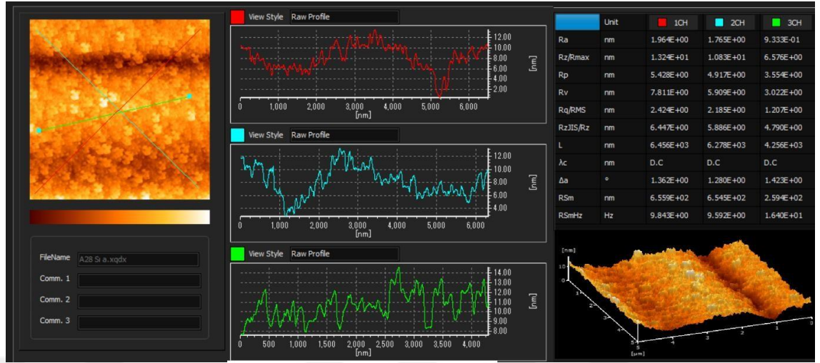
Şekil 4.35. Silisyum üzerine büyütülmüş AlN filmlerinden B12 filminin AFM ile alınmış görüntüsü
