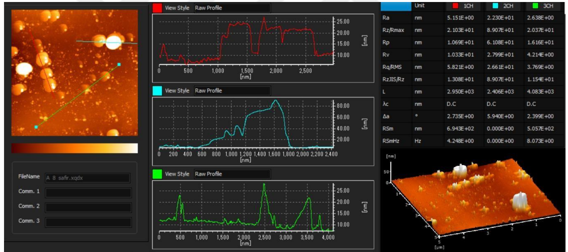
Şekil 4.9. Safır üzerine büyütülmüş AlN filmlerinden B3 filminin AFM ile alınmış görüntüsü
