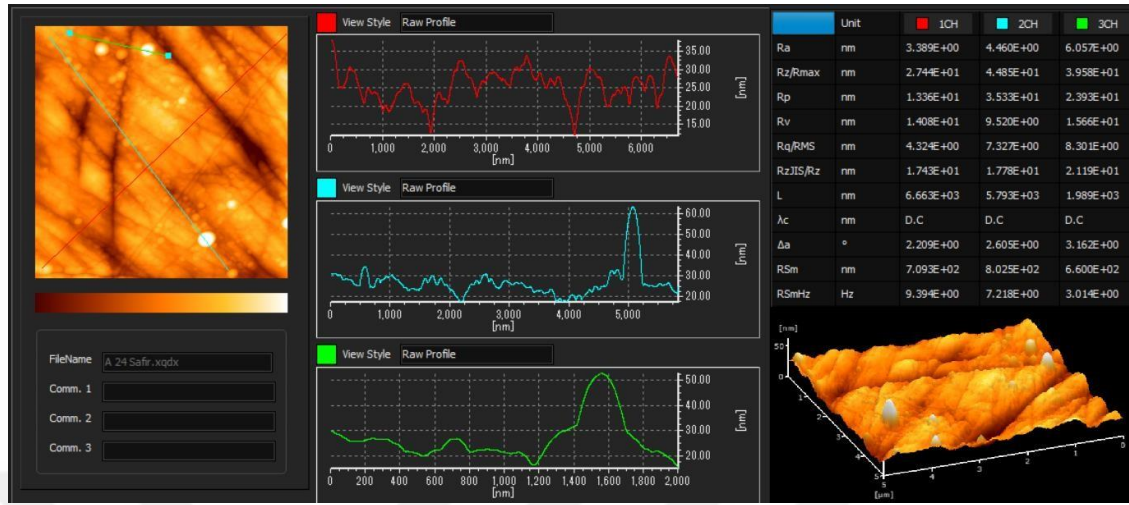
Şekil 4.33. Safir üzerine büyütülmüş AlN filmlerinden B10 filminin AFM ile alınmış görüntüsü
