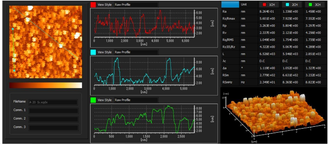
Şekil 4.26. Silisyum üzerine büyütülmüş AlN filmlerinden B9 filminin AFM ile alınmış görüntüsü
