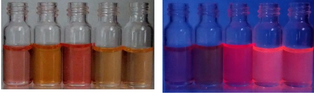
Resim 5.4. 4ç bileşiğinin farklı çözücüler içindeki gün ışığında (sol) ve UV ışığı ( \lambda_{uyarılma}=365 nm) altında (sağ) alınan fotoğrafları. Sırasıyla soldan sağa çözücüler; DMSO, Aseton, DCM, DIOX, THF
