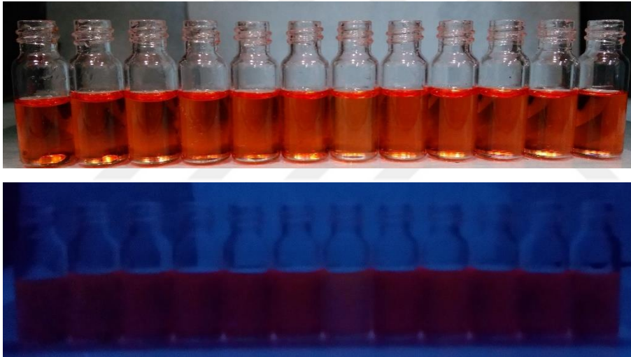
Resim 5.18. 4f bileşiğinin DMSO içindeki gün ışığında (üst) ve UV ışığı ( \lambda_{uyarılma}=365 nm) altında (alt) alınan fotoğrafları. Sırasıyla soldan sağa anyonlar; F^- , Cl^- , Br^- , I^- , AcO^- , H_2PO_4^- , ClO_4^- , CN^- , HSO_4^- , NO_3^- , ve OH^-
