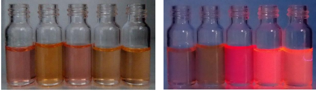
Resim 5.8. 4g bileşiminin farklı çözücüler içindeki gün ışığında (sol) ve UV ışığı ( \lambda_{uyarıma}=365 nm) altında (sağ) alınan fotoğrafları. Sırasıyla soldan sağa çözücüler; DMSO, Aseton, DCM, DIOX, THF
