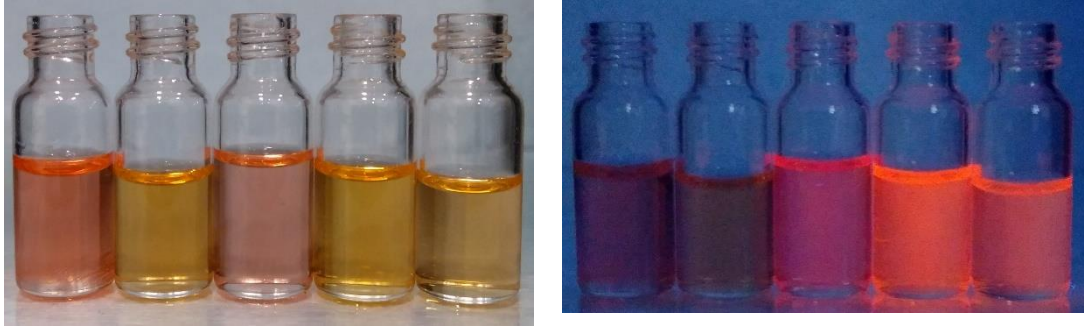
Resim 5.7. 4f bileşiğinin farklı çözücüler içindeki gün ışığında (sol) ve UV ışığı ( \lambda_{uyarılma}=365 nm) altında (sağ) alınan fotoğrafları. Sırasıyla soldan sağa çözücüler; DMSO, Aseton, DCM, DIOX, THF
