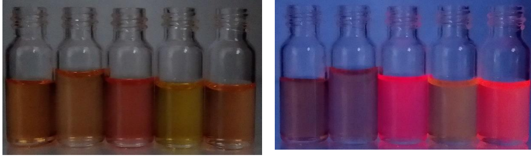
Resim 5.11. 4i bileşiğinin farklı çözücüler içindeki gün ışığında (sol) ve UV ışığı ( \lambda_{uyarılma}=365 nm) altında (sağ) alınan fotoğrafları. Sırasıyla soldan sağa çözücüler; DMSO, Aseton, DCM, DIOX, THF
