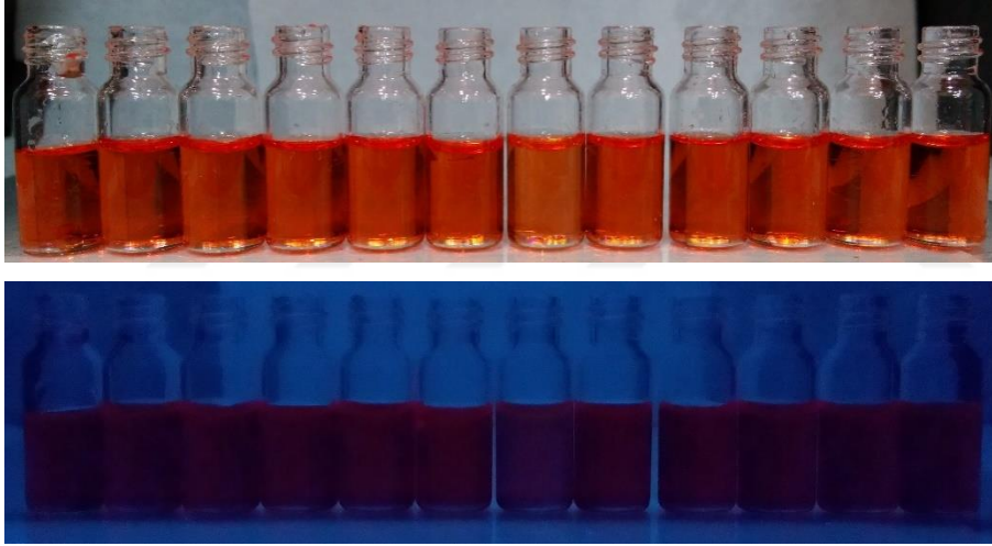
Resim 5.16. 4d bileşiğinin DMSO içindeki gün ışığında (üst) ve UV ışığı ( \lambda_{\text{uyarılma}}=365 \text{ nm} ) altında (alt) alınan fotoğrafları. Sırasıyla soldan sağa anyonlar; \text{F}^- , \text{Cl}^- , \text{Br}^- , \text{I}^- , \text{AcO}^- , \text{H}_2\text{PO}_4^- , \text{ClO}_4^- , \text{CN}^- , \text{HSO}_4^- , \text{NO}_3^- , ve \text{OH}^-
