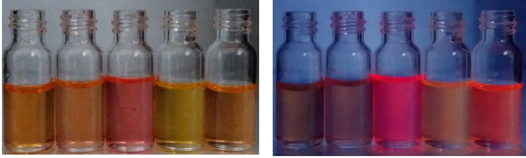
Resim 5.10. 4i bileşiğinin farklı çözücüler içindeki gün ışığında (sol) ve UV ışığı ( \lambda_{uyarılma}=365 nm) altında (sağ) alınan fotoğrafları. Sırasıyla soldan sağa çözücüler; DMSO, Aseton, DCM, DIOX, THF
