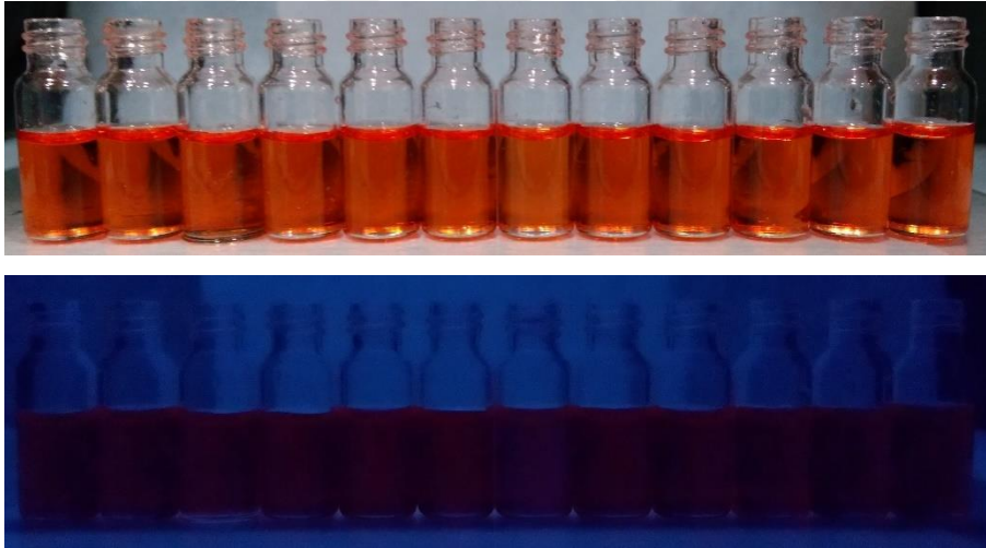
Resim 5.13. 4b bileşiğinin DMSO içindeki gün ışığında (üst) ve UV ışığı ( \lambda_{uyarılma}=365\text{ nm} ) altında (alt) alınan fotoğrafları. Sırasıyla soldan sağa anyonlar; F - , Cl - , Br - , I - , AcO - , H 2 PO 4 - , ClO 4 - , CN - , HSO 4 - , NO 3 - , ve OH -
