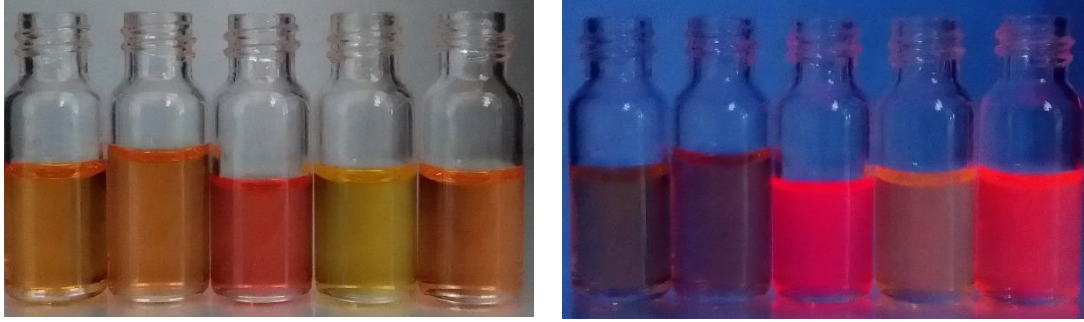
Resim 5.9. 4h bileşiğinin farklı çözücüler içindeki gün ışığında (sol) ve UV ışığı ( \lambda_{uyarılma}=365 nm) altında (sağ) alınan fotoğrafları. Sırasıyla soldan sağa çözücüler; DMSO, Aseton, DCM, DIOX, THF
