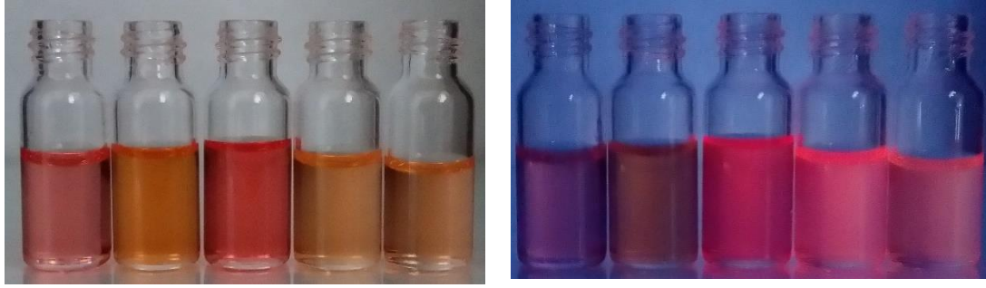
Resim 5. 3. 4c bileşiğinin farklı çözücüler içindeki gün ışığında (sol) ve UV ışığı ( \lambda_{uyarılma}=365 nm) altında (sağ) alınan fotoğrafları. Sırasıyla soldan sağa çözücüler; DMSO, Aseton, DCM, DIOX, THF
