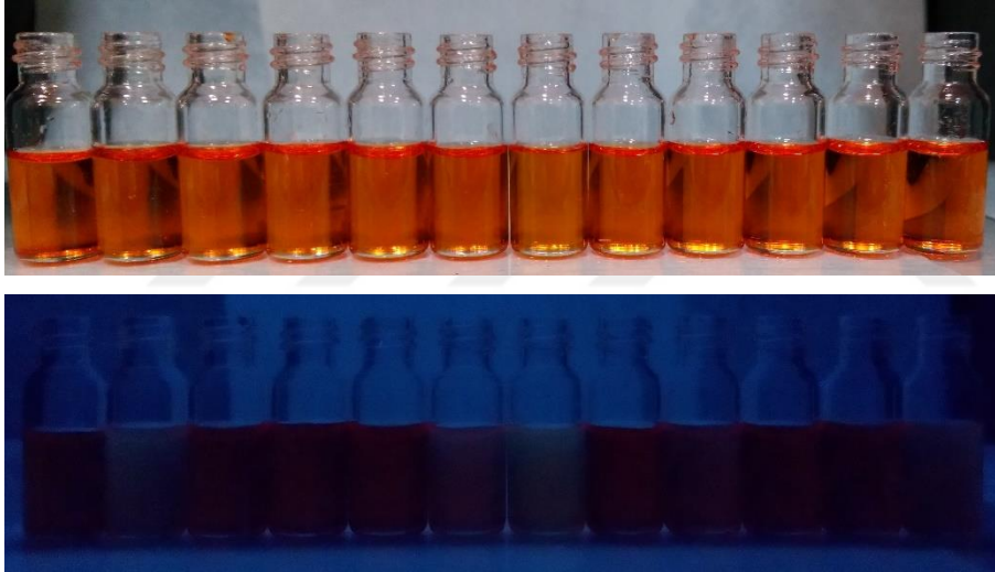
Resim 5.22. 4i bileşiğinin DMSO içindeki gün ışığında (üst) ve UV ışığı ( \lambda_{\text{uyarılma}}=365 \text{ nm} ) altında (alt) alınan fotoğrafları. Sırasıyla soldan sağa anyonlar; \text{F}^- , \text{Cl}^- , \text{Br}^- , \text{I}^- , \text{AcO}^- , \text{H}_2\text{PO}_4^- , \text{ClO}_4^- , \text{CN}^- , \text{HSO}_4^- , \text{NO}_3^- , ve \text{OH}^-
