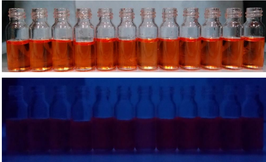
Resim 5. 12. 4a bileşiğinin DMSO içindeki gün ışığında (üst) ve UV ışığı ( \lambda_{uyarılma}=365 nm) altında (alt) alınan fotoğrafları. Sırasıyla soldan sağa anyonlar; F^- , Cl^- , Br^- , I^- , AcO^- , H_2PO_4^- , ClO_4^- , CN^- , HSO_4^- , NO_3^- , ve OH^-
