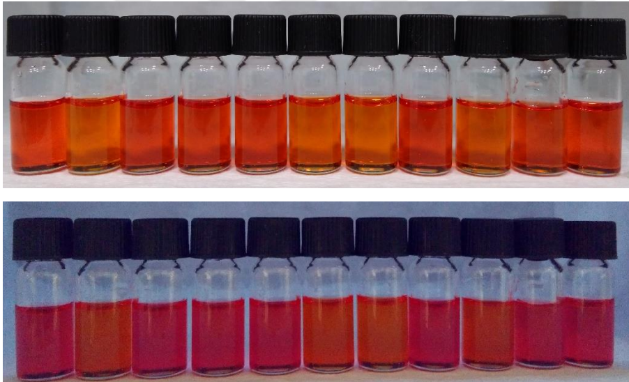
Resim 5.14. 4c bileşiğinin DMSO içindeki gün ışığında (üst) ve UV ışığı ( \lambda_{uyarılma}=365 nm) altında (alt) alınan fotoğrafları. Sırasıyla soldan sağa anyonlar; F^- , Cl^- , Br^- , I^- , AcO^- , H_2PO_4^- , ClO_4^- , CN^- , HSO_4^- NO_3^- , ve OH^-
