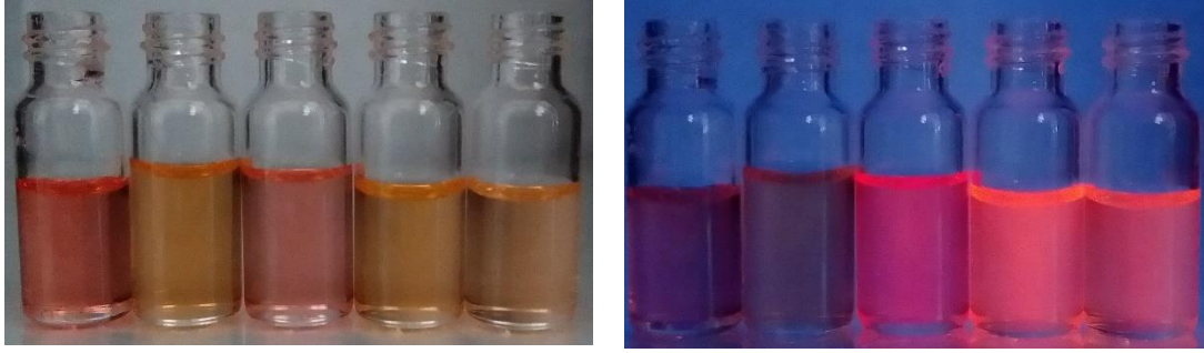
Resim 5.5. 4d bileşiminin farklı çözücüler içindeki gün ışığında (sol) ve UV ışığı ( \lambda_{uyarılma}=365 nm) altında (sağ) alınan fotoğrafları. Sırasıyla soldan sağa çözücüler; DMSO, Aseton, DCM, DIOX, THF
