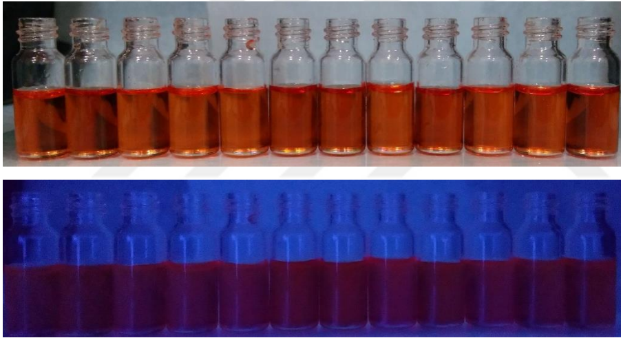
Resim 5. 19. 4g bileşiğinin DMSO içindeki gün ışığında (üst) ve UV ışığı ( \lambda_{\text{uyarılma}}=365 nm) altında (alt) alınan fotoğrafları. Sırasıyla soldan sağa anyonlar; \text{F}^- , \text{Cl}^- , \text{Br}^- , \text{I}^- , \text{AcO}^- , \text{H}_2\text{PO}_4^- , \text{ClO}_4^- , \text{CN}^- , \text{HSO}_4^- \text{NO}_3^- , ve \text{OH}^-
