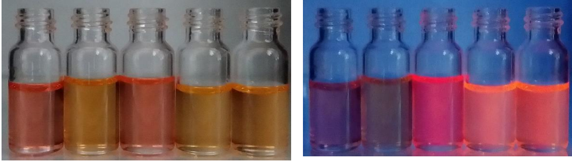
Resim 5.1. 4a bileşiğinin farklı çözücüler içindeki gün ışığında (sol) ve UV ışığı ( \lambda_{uyarılma}=365 nm) altında (sağ) alınan fotoğrafları. Sırasıyla soldan sağa çözücüler; DMSO, Aseton, DCM, DIOX, THF.
