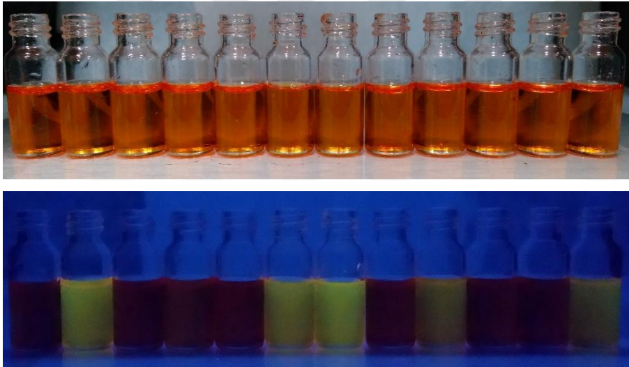
Resim 5.21. 4ı bileşğinin DMSO içindeki gün ışığında (üst) ve UV ışığı ( \lambda_{uyarılma}=365\text{ nm} ) altında (alt) alınan fotoğrafları. Sırasıyla soldan sağa anyonlar; \text{F}^- , \text{Cl}^- , \text{Br}^- , \text{I}^- , \text{AcO}^- , \text{H}_2\text{PO}_4^- , \text{ClO}_4^- , \text{CN}^- , \text{HSO}_4^- , \text{NO}_3^- , ve \text{OH}^-
