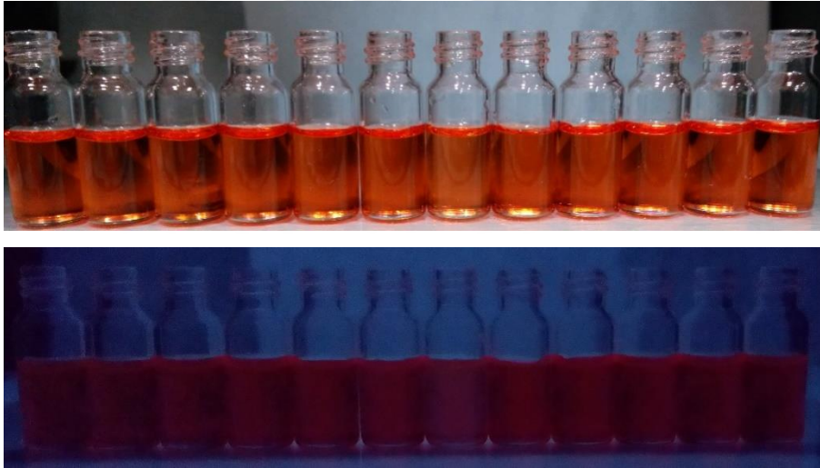
Resim 5.15. 4ç bileşiğinin DMSO içindeki gün ışığında (üst) ve UV ışığı ( \lambda_{uyarılma}=365 nm) altında (alt) alınan fotoğrafları. Sırasıyla soldan sağa anyonlar; F^- , Cl^- , Br^- , I^- , AcO^- , H_2PO_4^- , ClO_4^- , CN^- , HSO_4^- , NO_3^- , ve OH^-
