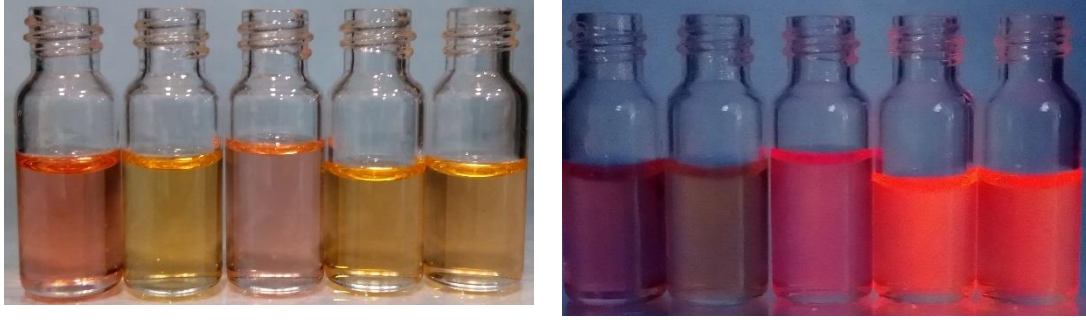
Resim 5.6. 4e bileşiğinin farklı çözücüler içindeki gün ışığında (sol) ve UV ışığı ( \lambda_{uyarılma}=365 nm) altında (sağ) alınan fotoğrafları. Sırasıyla soldan sağa çözücüler; DMSO, Aseton, DCM, DIOX, THF
