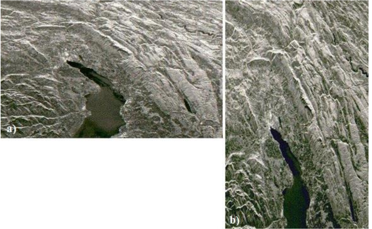
Şekil 2.10. a) Eğik mesafe görüntüsü ve b) yatay mesafe görüntüsü
