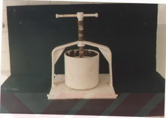
Resim 3. Esas çalışmada kullanılan pres makinası
