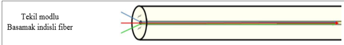
Şekil 3.1. Tek modlu basamak indisli fiber
