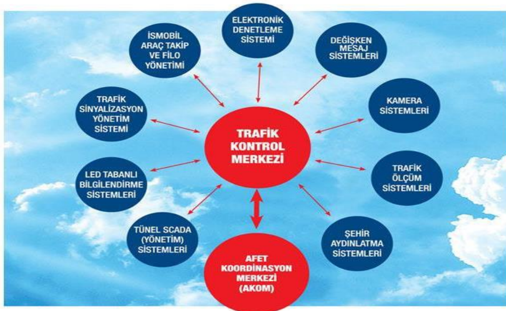
Şekil 4.4. İBB trafik kontrol merkezi şeması (İSBAK, 2014a)
