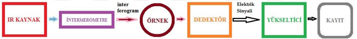
Şekil 3.8: FT-IR spektrometrelerinin blok diyagramı [16].
