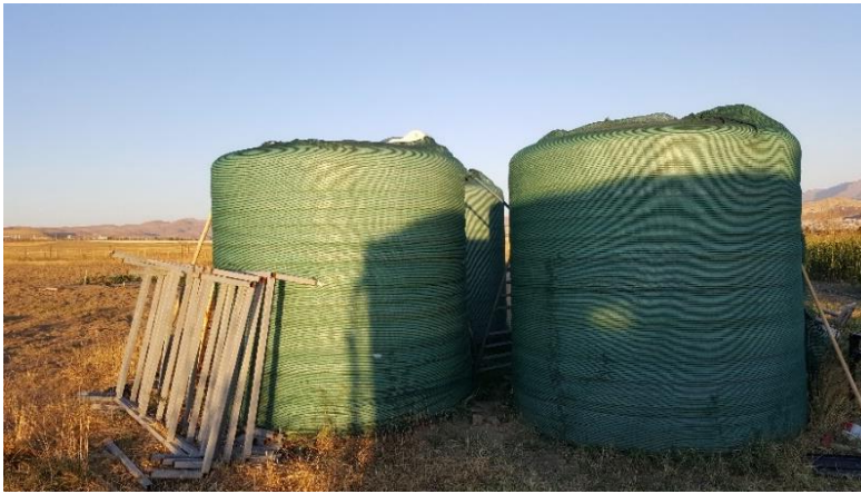
Şekil 3.8. Arıtılmış atık suyun deneme alanında depolanması
