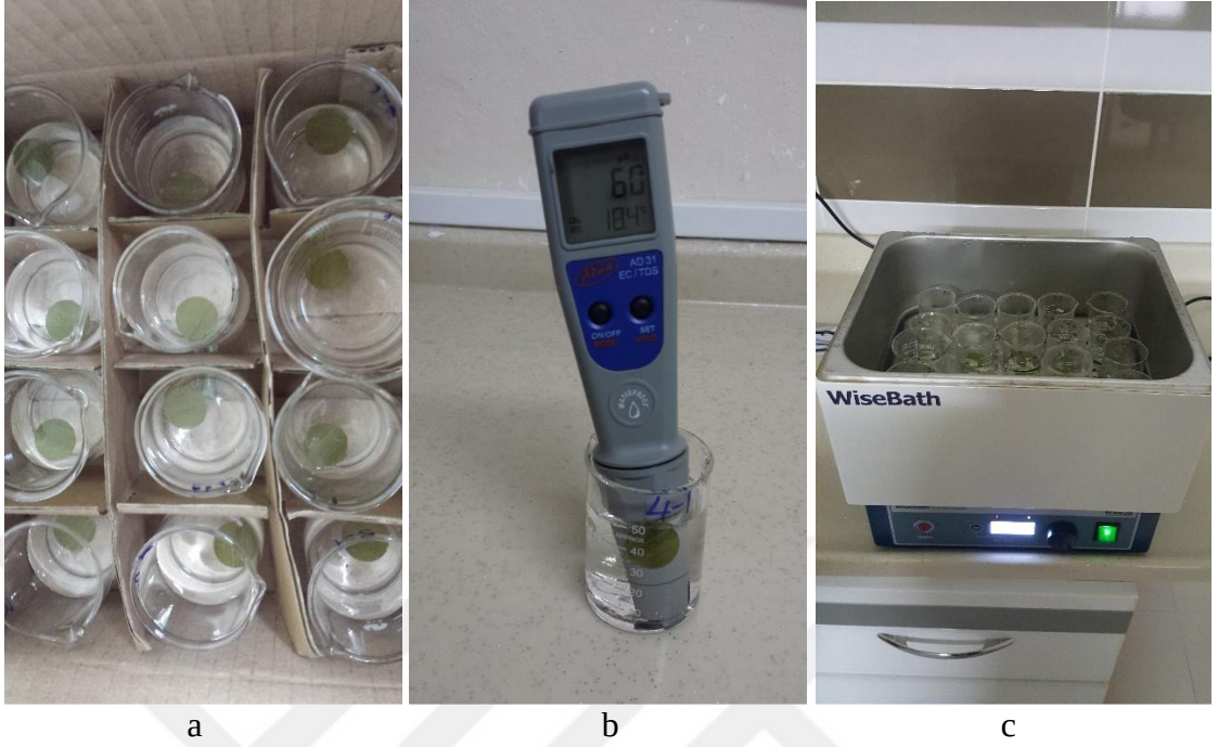
Şekil 3.22. Membran zararlamasının belirlenmesi a) 24 saat bekletme, b) EC değerlerinin ölçülmesi, c) sıcak su banyosunda bekletme
