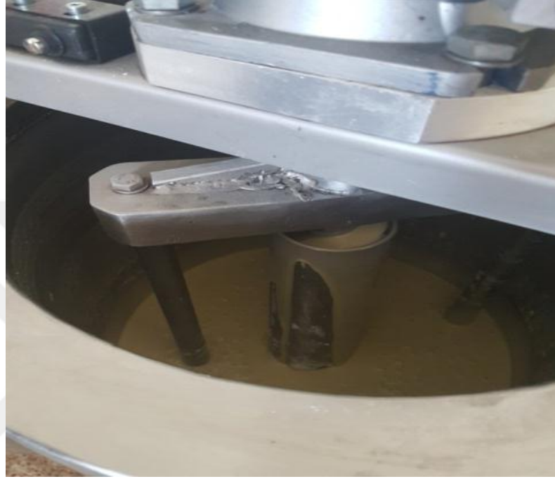
Şekil 3.3 Bilyalı değirmen heliks bölümü sirkülasyonu
