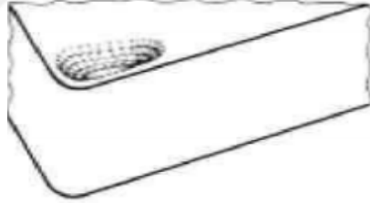
Şekil 2.10: Krater aşınması (Özdemir ve Erten, 2003).
