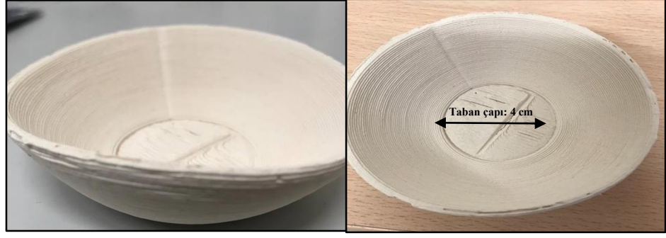
Şekil 8.33. %75 katı oranı ve kütlece %0,07 \text{CaCl}_2 tuzu içeren V9-2 reçetesinin 45^\circ konik şekilde WASP 2040 modelli 3B yazıcıda yazım sonrası pişmiş görünümü (taban çapı: 4 cm)
