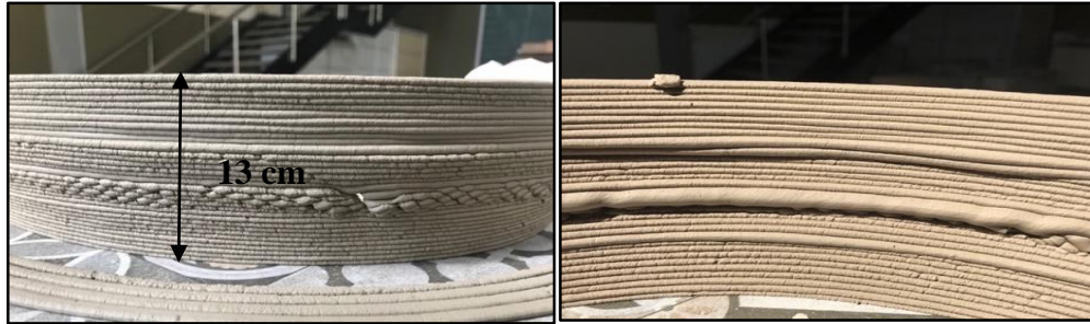
Şekil 8.43. %81 katı oranı ve kütlece %0,07 \text{CaCl}_2 tuzu içeren FFC-322 reçetesinin oval şekilde WASP 3MT modeli 3B yazıcıda yazımı sonrası kuru görünümleri
