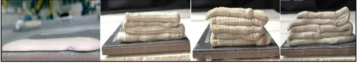
Şekil 8.26. Fireclay 322 reçetesi çamurlarının sırasıyla tuz ilavesiz, %0,07 CaCl 2 , %0,09 CaCl 2 ve %0,11 CaCl 2 ilaveli yığılma görüntüleri
