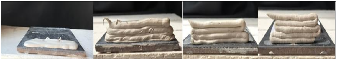
Şekil 8.25. V9-2 reçetesi çamurlarının sırasıyla tuz ilavesiz, %0,03 CaCl_2 , %0,05 CaCl_2 ve %0,07 CaCl_2 ilaveli yığılma görüntüleri
