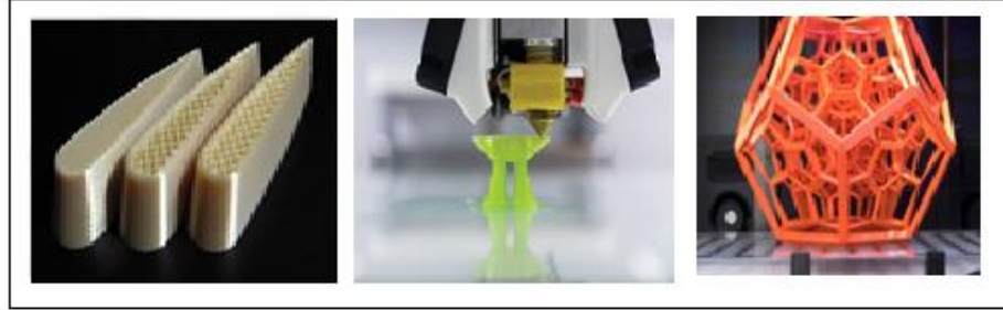
Şekil 5.4. Eriyik Yığılma Modelleme ( Fused Deposition Modelling-FDM ) yöntemi ile elde edilen ürünler [anonim]
