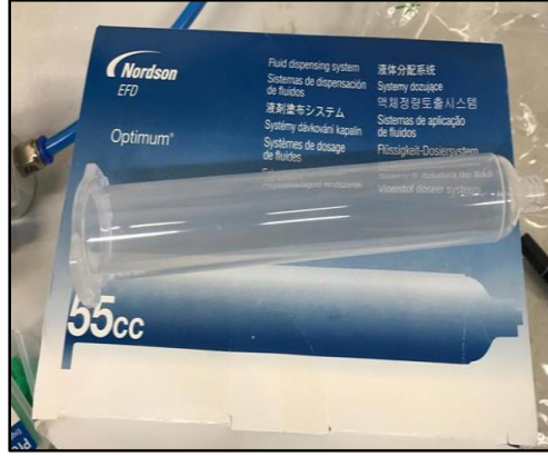
Şekil 7.5. 3 boyutlu yazımda kullanılan 55 ml hacme sahip plastik tüp
