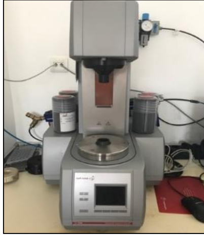
Şekil 7.1. Reolojik karakterizasyonda kullanılan Anton Paar reometre cihazı
