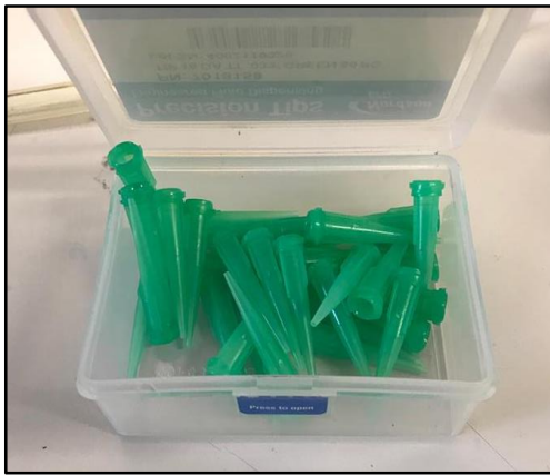
Şekil 7.4. 3 boyutlu yazımda kullanılan 0,8 mm genişliğinde plastik nozüller
