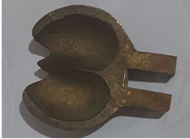
Şekil 3.2 Tasarlanmış ve imal edilmiş Pelton türbini kepçesi
