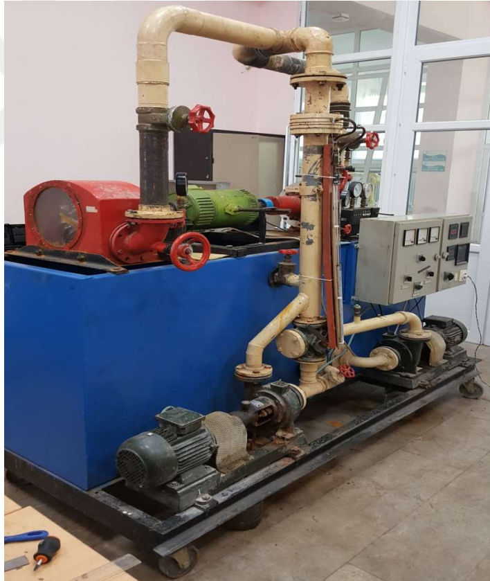
Şekil 3.1. Deney çalışmasında kullanılan Pelton türbini deney seti
