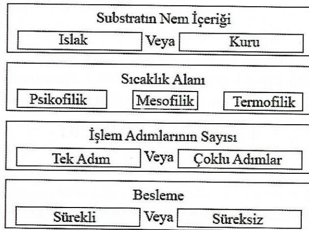
Şekil 3.4. Reaktör tasarımına etki eden değişkenler (Kaya ve Öztürk, 2012).
