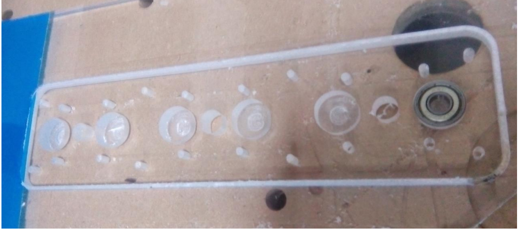
Şekil 5.3. CNC Router'da işlenen üst tabla
