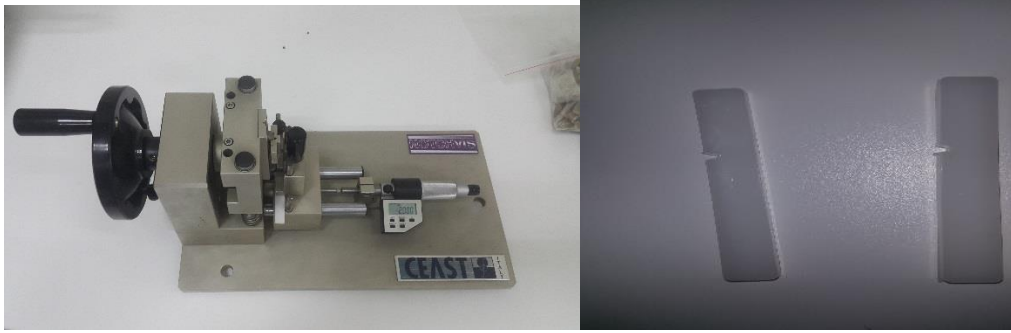
Şekil 2.17 Çentik cihazı ile çentik açma (V çentik, 2mm)
