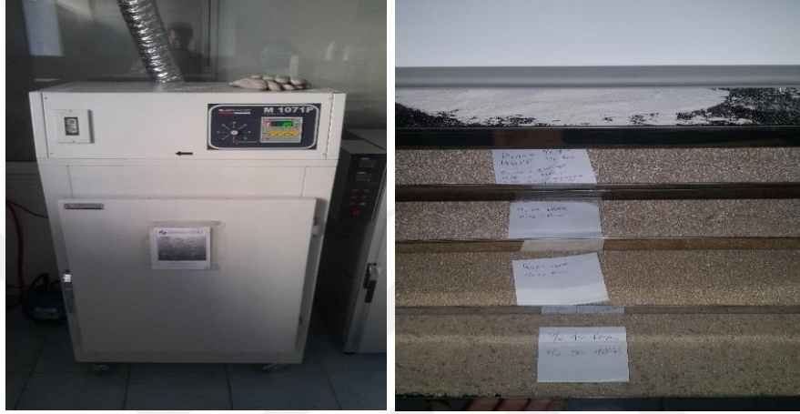
Şekil 2.9 Etüv ve YYPE/ Pinna Nobilis granüllerin kurutulması
