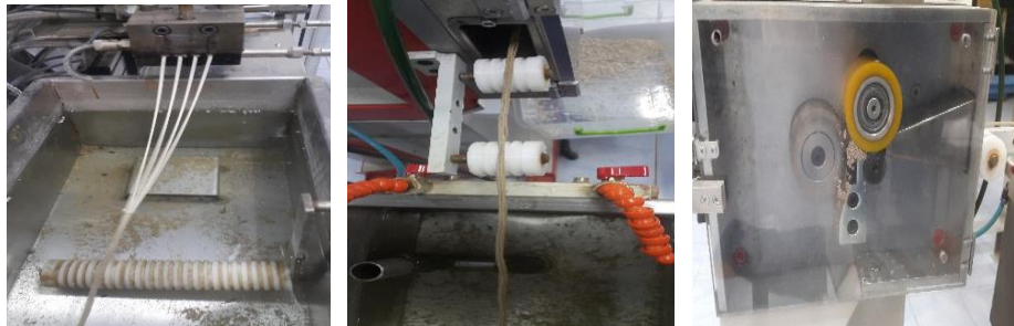
Şekil 2.8 YYPE/Pinna Nobilis karışımlarının granül hale getirilmesi
