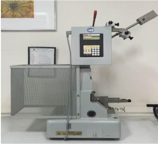
Şekil 2.18 Darbe cihazı ve testin uygulanışı
