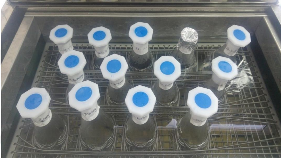
Şekil 3.7. Adsorpsiyon işleminin gerçekleştiği çalkalamalı su banyosu ve numuneler
