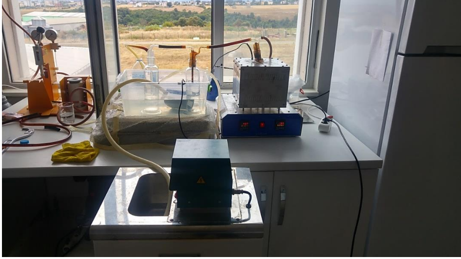
Şekil 3.3. Piroliz reaktörü deney düzeneği
