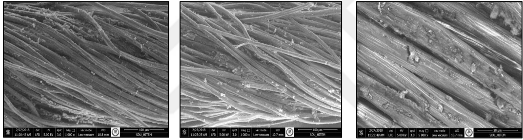
Şekil 4.3. % 1.0 konsantrasyonda karbon siyahı dispersiyonu applike edilmiş Ne 30/1 numara % 100 pamuk ipliklerine ait görüntüler
