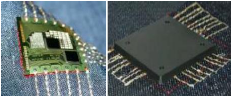
Şekil 1.30. Esnek elektronik modülün nakış yoluyla iletken iplik ile bağlanması ve kot kumaşı üzerinde kapsülasyon yapılması (Linz vd., 2005)
