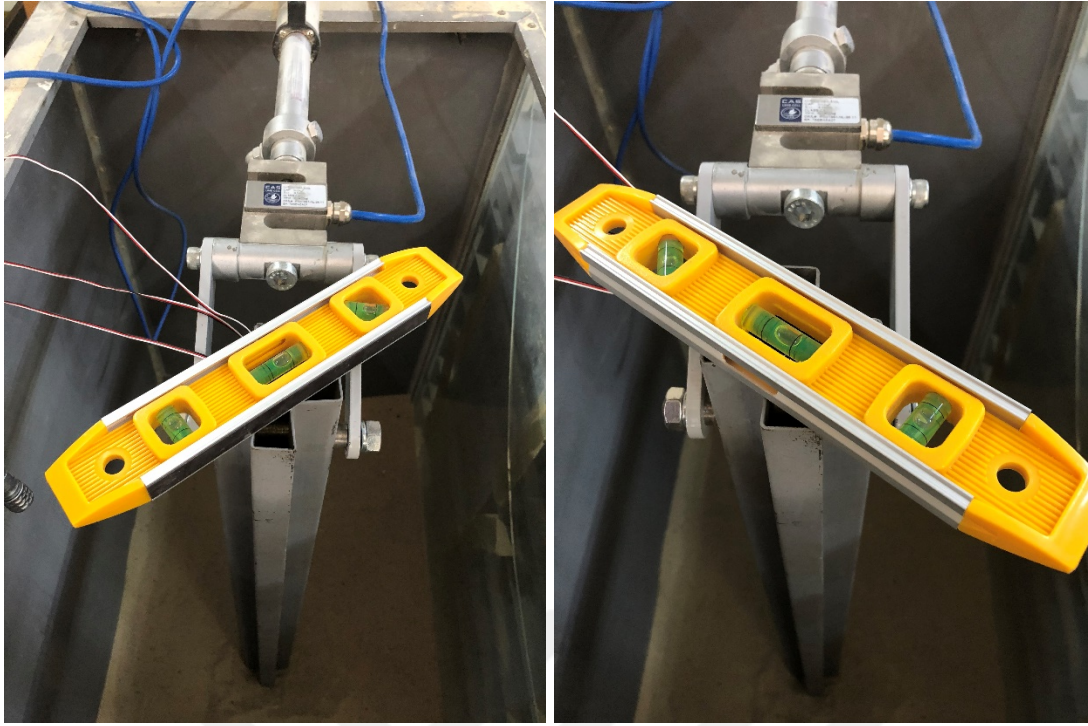
Şekil 4.46 : Su terazisi ile profil başı yataylığının kontrolü.
