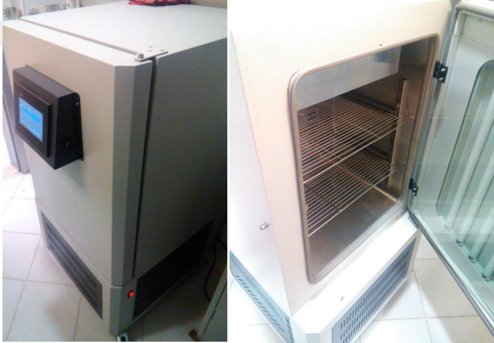
Şekil 3.1. MIT 120 İklimlendirme ve Test Kabini.
