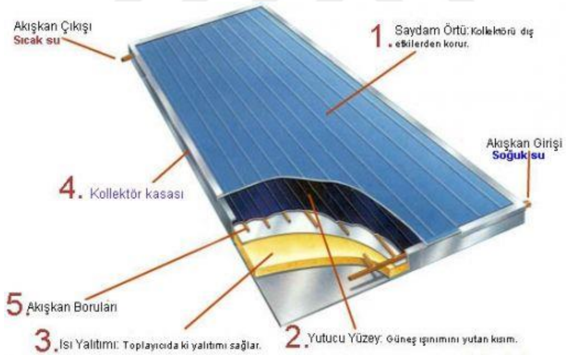
Şekil 2.10. Kollektör Sistemi Basit Gösterimi Ve Ekipmanları[38]
