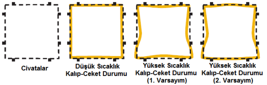
Şekil 8.6. Döküm esnasında kalıp-ceket etkileşimi (Unamuno, vd., 2009)
