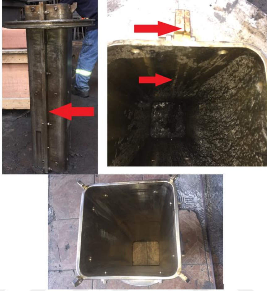
Şekil 8.5. Eski ceket (iki parça) ve yeni ceket (tek parça) görünümü
