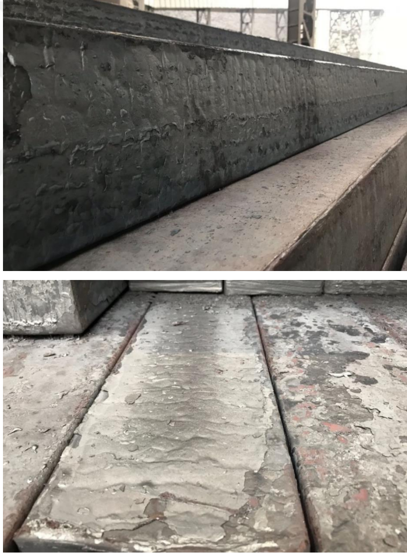
Şekil 9.5: Üretilen kütüklerdeki salınım izleri
