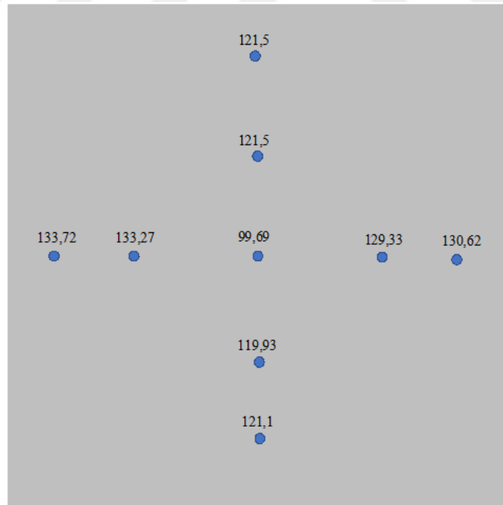
Şekil 9.14. Kalite A bileşimine sahip 3,5 m/dk hızla dökülmüş kütük kesiti üzerindeki Brinell sertlik ölçümü değerleri
