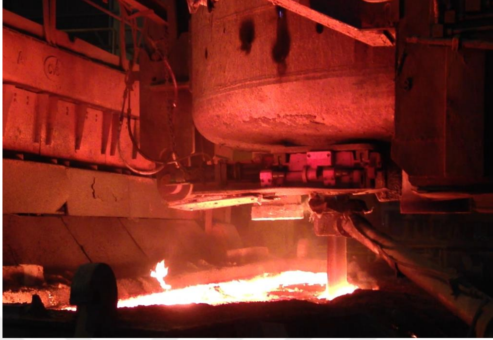
Şekil 8.14. Pota ve hazne arasında kullanılan aratüpün görünümü
