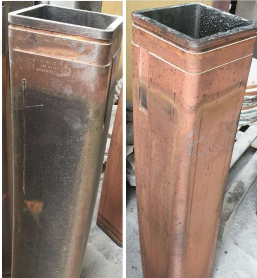
Şekil 9.4. Mevcut ceket (sol) ve yeni ceket (sağ) ile kullanılan kalıpların dış yüzey durumu
