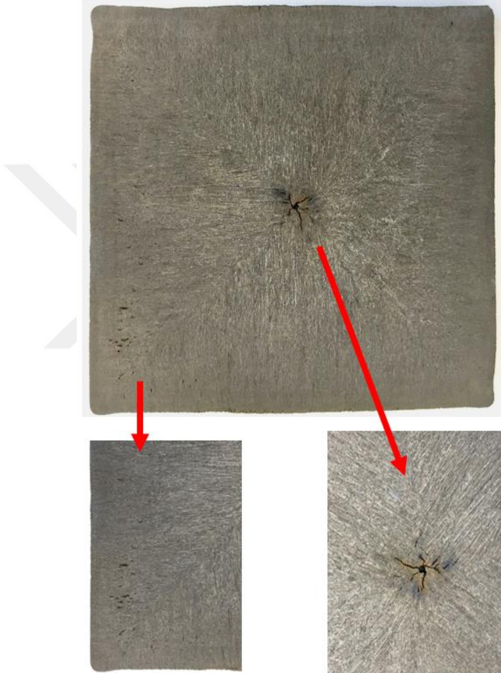
Şekil 9.22. Kalite C bileşimine sahip 3,0 m/dk hızla dökülmüş kütük kesitinin makro dağlama görünümdeki merkez çatlağı ve gaz boşluğu ayrıntıları
