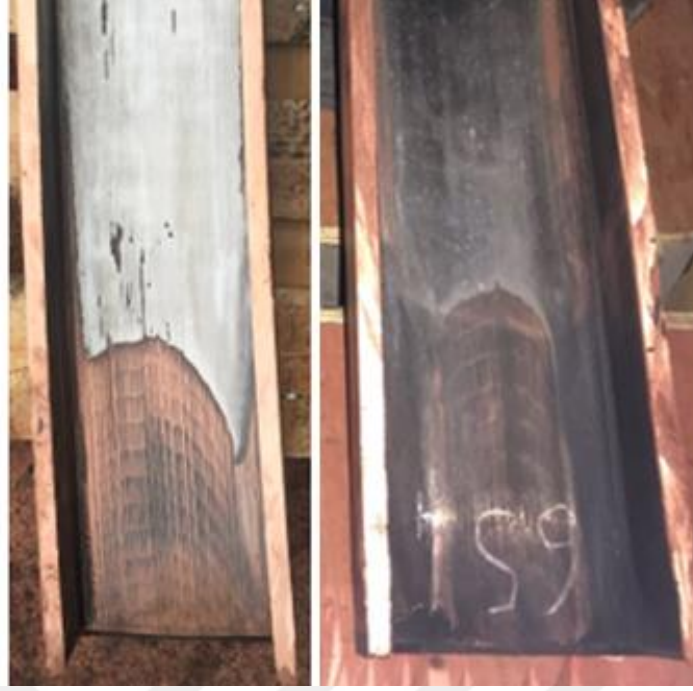
Şekil 9.3. Mevcut Kalıp (sol) ve Kalıp-2 (sağ) aşınma durumları
